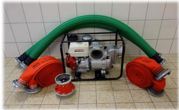
Pompa do wody zanieczyszczonej - 64 szt.
