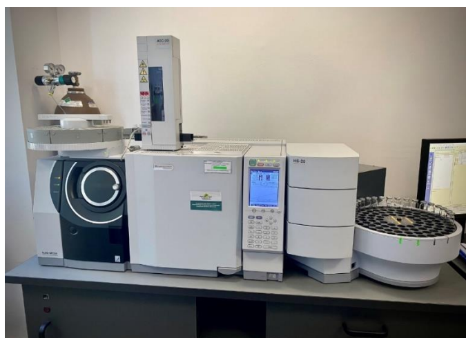
Zdjęcie nr 27. Chromatograf gazowy z detektorem mas i podajnikiem fazy nadpowierzchniowej typu „headspace” (źródło: zasoby własne WSSE)
