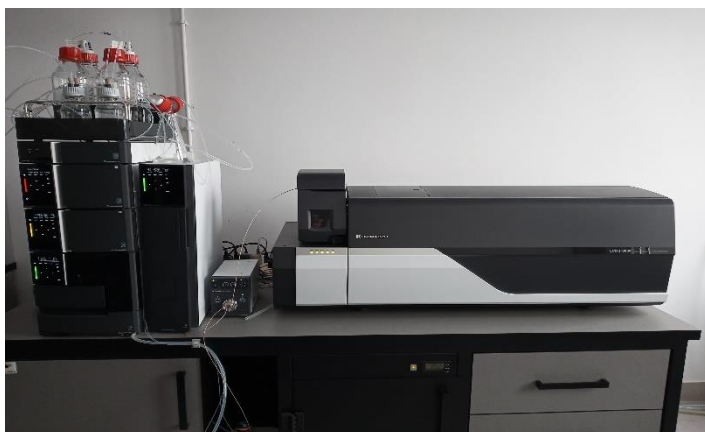
Zdjęcie nr 26 Chromatograf ciekowy z detektorem mas typu potrójny kwadrupol (źródło: zasoby WSSE Rzeszów)
