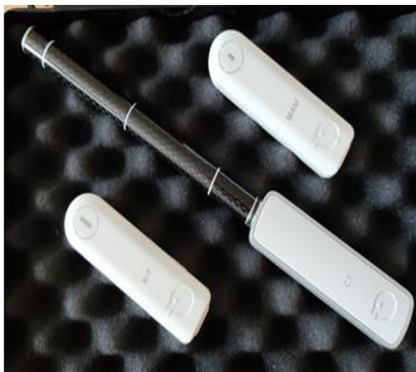
Zdjęcie nr 38,39. Wyposażenie do kontroli jakości aparatów wrtg: mammograficznych, efalometrycznych i tomografii komputerowej.
