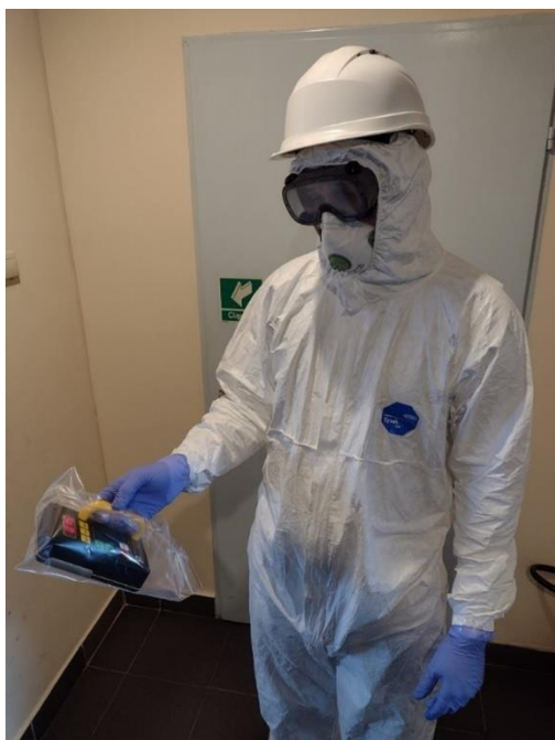
Zdjęcie nr 31. Sposób zabezpieczenia dozymetrysty i miernika pomiarowego (źródło: zasoby własne WSSE)
