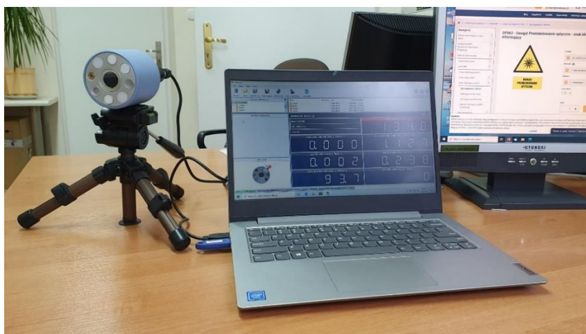
Zdjęcie nr 43.Miernik do pomiaru natężenia promieniowania UV, VIS, IR. (źródło: zasoby własne WSSE)
