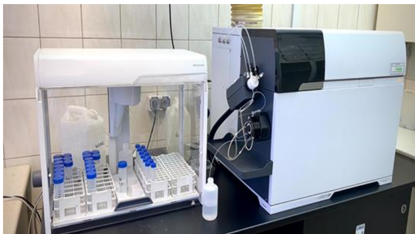
Zdjęcie nr 28. Spektrometr mas z plazmą indukcyjnie sprzężoną (źródło: zasoby własne WSSE)
