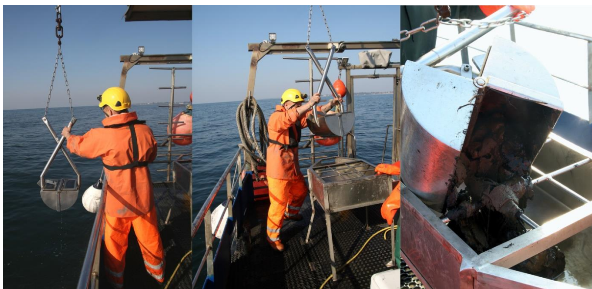
Fot. 5.1 Proces pobierania prób makrozoobentosu przy pomocy czerpacza van Veen
