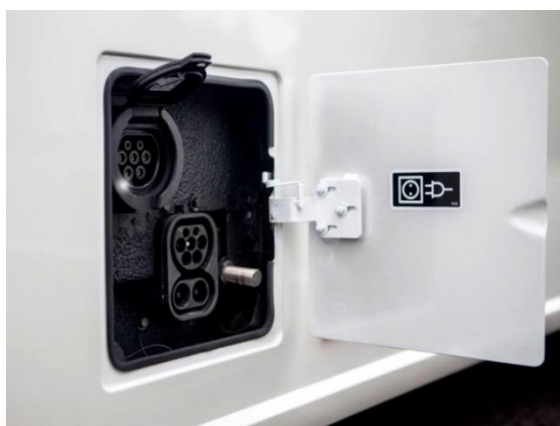
Rysunek 11. Gniazda do ładowania typu plug-in – type 2 „Mennekes” oraz CCS combo 2 w autobusie Solaris Urbino Electric 12 50
