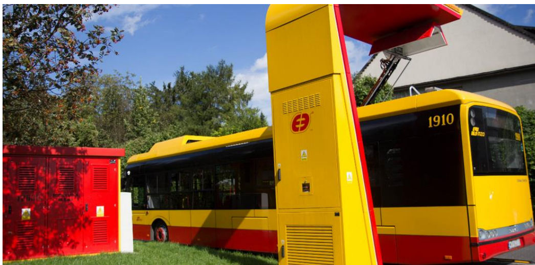
Rysunek 4. Stacje ładowania typu pantograf produkcji Ekoenergetyka Sp. z o.o. w Inowrocławiu 41
