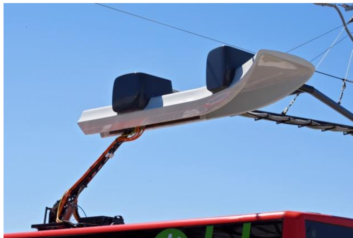
Rysunek 3. Układ ładowania pantografowego dla autobusu elektrycznego projektu EC Engineering Sp. z o.o. 39
