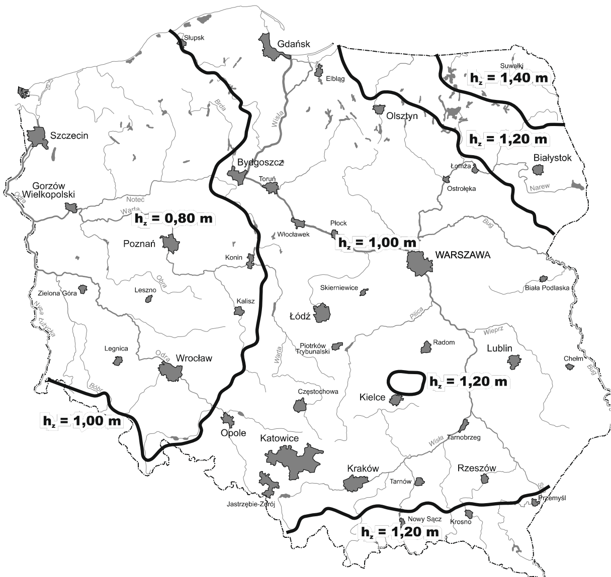
Rys.10.1.1. Głębokość przemarzania gruntu h_z według normy [2]
