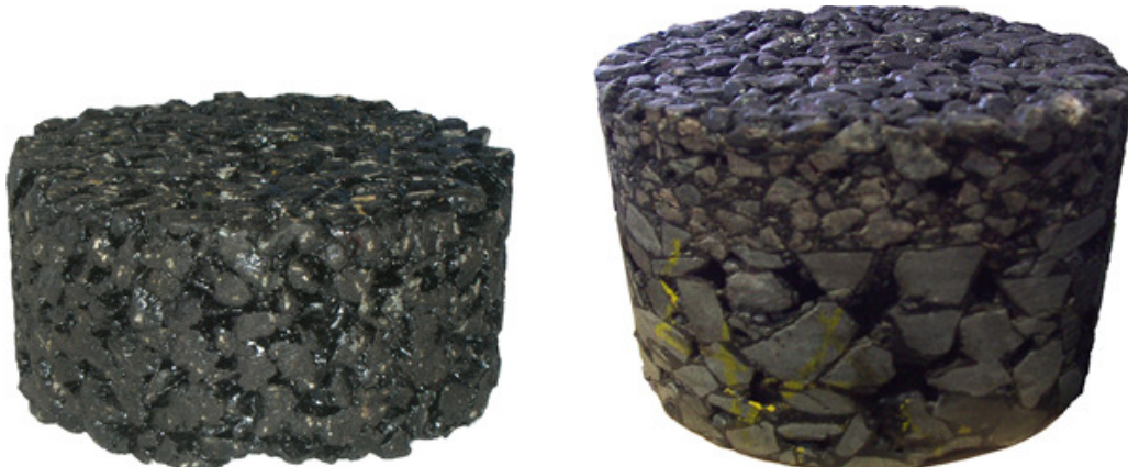
Fot. 3.6 Widok próbek z asfaltu porowatego
