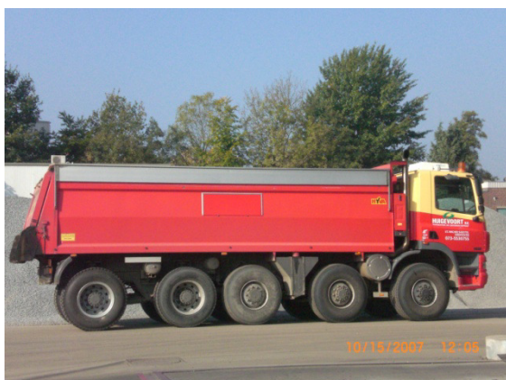
Fot. 3.3 Widok samochodów samowyładowczych a) postój pięcioosiowego b) manewrowanie sześćoosiowego
