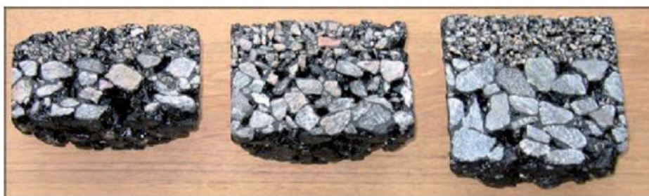
Fot. 1.5 Przekroje próbek nawierzchni asfaltu porowatego dwuwarstwowego [13]
