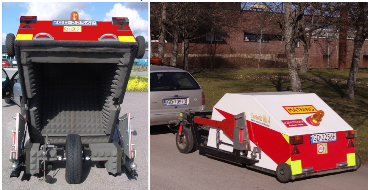
Fot. 4.1 Przyczepa pomiarowa Tiresonic Mk 4 do badania hałasu opon samochodowych i nawierzchni drogowych zaprojektowana i wykonana w Politechnice Gdańskiej
