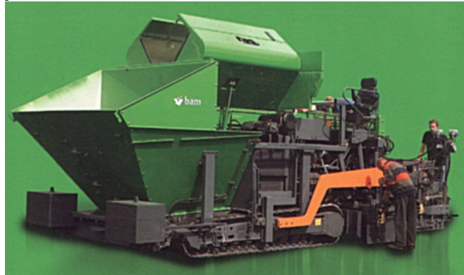
Fot. 3.7 Widok maszyny do układania warstw kompaktowych
