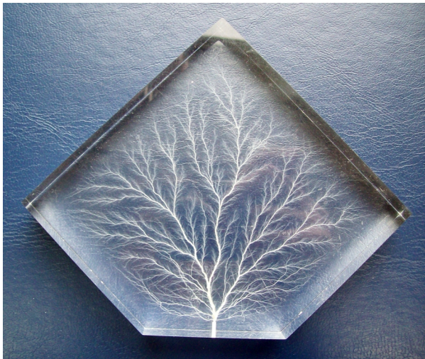
Fot. 5. Ślad ładunku (elektronów), które w postaci iskry opuściły płytkę z polimetakrylanu metylu. Wcześniej materiał (kondensator) napromieniowano wiązką elektronów (napompowano elektronami powstającymi w wyniku jonizacji).
