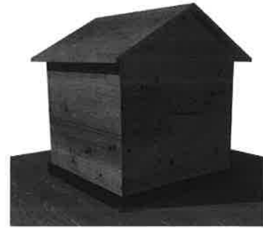
Widok budki zabezpieczającej otwór rewizyjny
