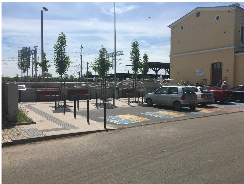
Rysunek 19. Na dworcu kolejowym- ścieżka dla osób niewidomych, tyflomapa, parking kiss&ride , parking dla osób z niepełnosprawnościami, tuż obok pochylnia dla wózków - .
