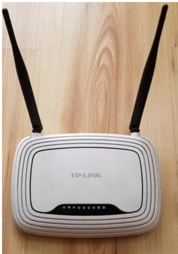
Fot. 2: Zdjęcie punktu dostępowego model TL-WR841N*
