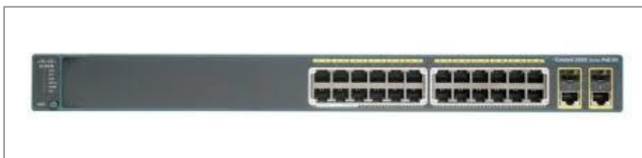
Fot. 23 Przełącznik WS-C2960L-24PS-LL zakupiony przez KW PSP łączący sieci LAN komend z urządzeniem brzegowym sieci OST112.
