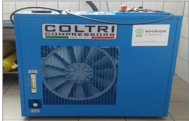
Sprężarka do ładowania butli - 2 szt.
