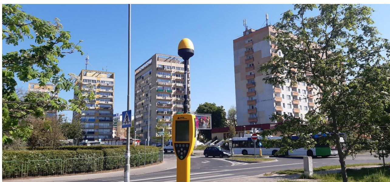
Fotografia 1. Pomiar pól elektromagnetycznych miernikiem Narda NBM-550 - punkt Z_2021_A_1, punkt Z_2021_A_6 (źródło: CLB Oddział w Szczecinie)
