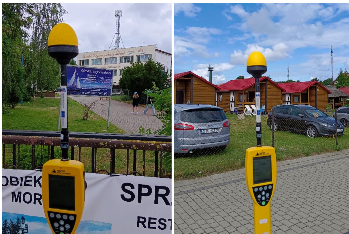
Fotografia 2. Pomiar pól elektromagnetycznych miernikiem Narda NBM-550 - punkt Z_2023_GW_2, punkt Z_2023_GW_8 (źródło: CLB Oddział w Szczecinie)
