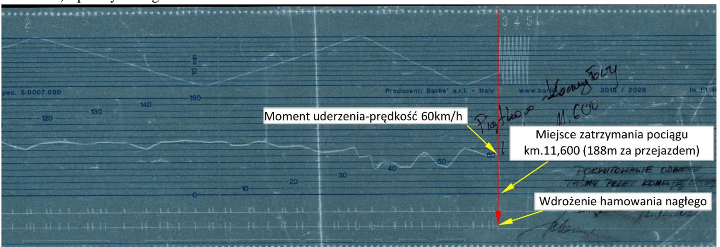
Zdjęcie 5 – Skan taśmy prędkościomierza z zarejestrowaną charakterystyką jazdy pociągu nr 872000
