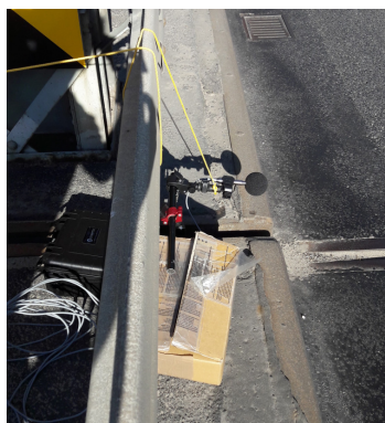
Rys. 12.19 Widok na punkt pomiarowy PPH-4 przy dylatacji jednomodułowej
