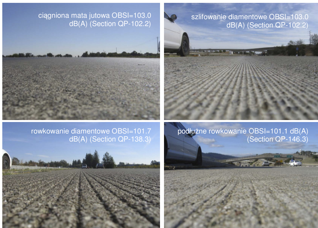
Rys. 3.8. Badane struktury podłużne powierzchni oraz poziomy hałas wg [56]
