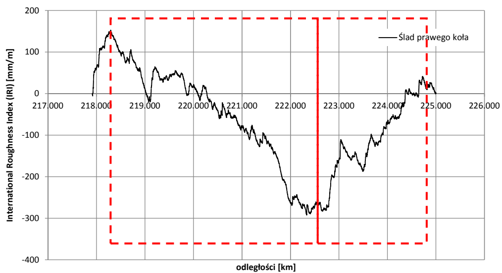
Rys. 5.15. Wyniki pomiarów na długości badanego odcinka – International Roughness Index (IRI) (droga S8, pas prawy, jezdnia północna)
