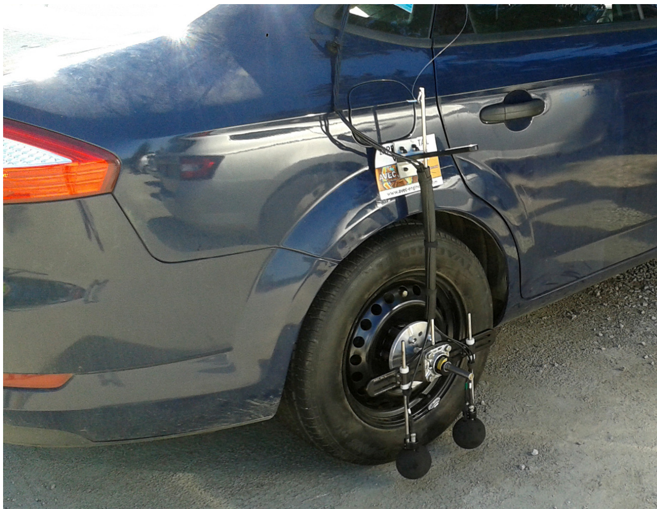
Rys. 4.2. Lokalizacja mikrofonów w metodzie OBSI
