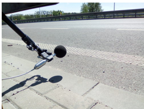
Rys. 12.16 Widok na punkt pomiarowy PPH-2 przy nawierzchni jezdni (punkt bazowy)
