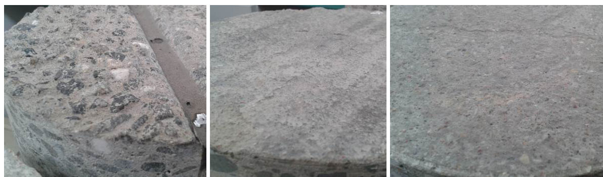
Rys. 7.13. Próbki badawcze z trzema typami tekstury nawierzchni betonowej (od lewej): odkryte kruszywo, tekstura poprzeczna, tekstura podłużna
