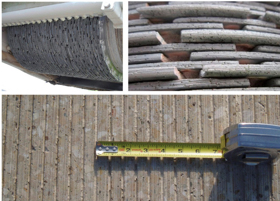
Rys. 3.4. Głowica oraz struktura powierzchni Next Generation Concrete NGCS [22]
