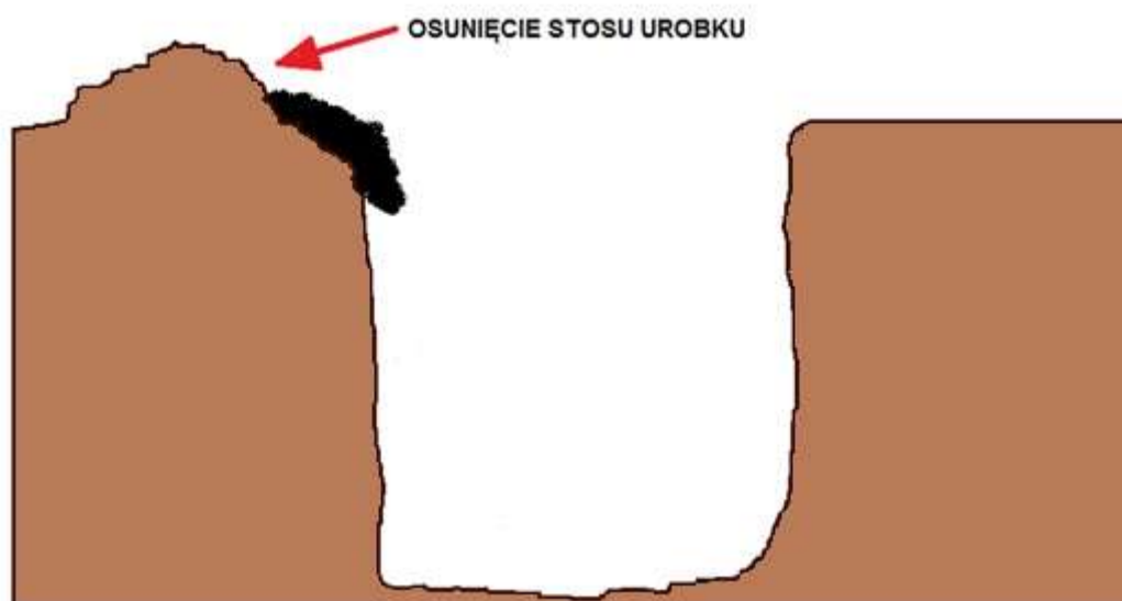
Rys. 8. Osunięcie stosu urobku
