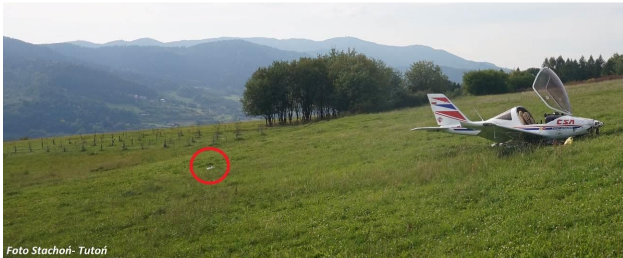
Ilustracja nr 4. Samolot po lądowaniu zapobiegawczym, zaznaczono położenie lewego podwozia głównego.
