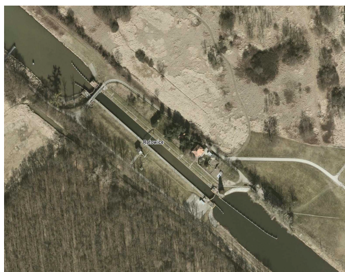
Rysunek 3. Stopień wodny Ratowice (km 227,4) z jedną dużą śluzą klasy III Źródło: Geoportal http://mapy.geoportal.gov.pl/imap
