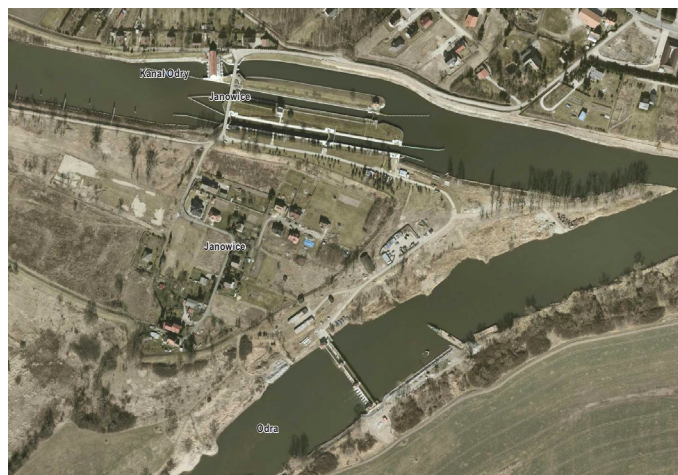
Rysunek 4. Stopień wodny Janowice (km 232,4) – duże śluzy, elektrownia wodna, jaz w starym korycie Źródło: Geoportal http://mapy.geoportal.gov.pl/imap
