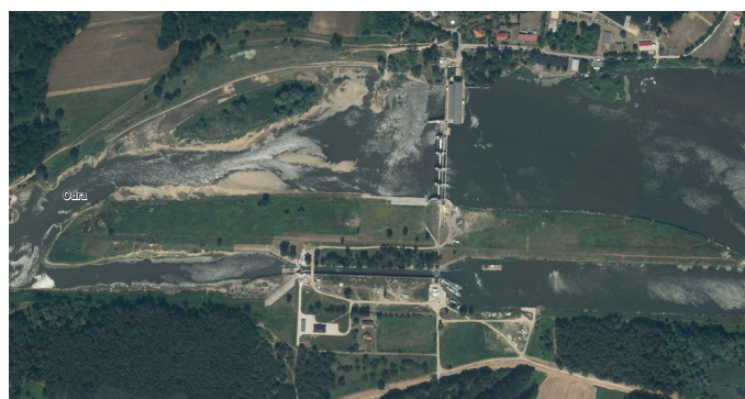
Rysunek 5. Stopień wodny Brzeg Dolny (km 281,6) – 1 śluza z parametrami IV klasy drogi wodnej Źródło: Geoportal http://mapy.geoportal.gov.pl/imap
