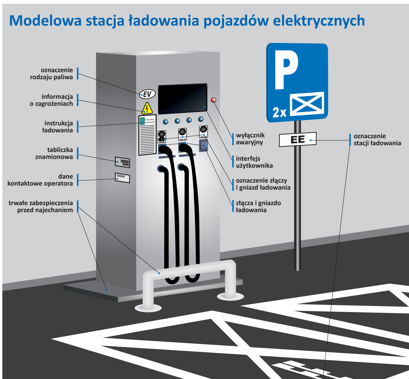
Rys. 2. Modelowa stacja ładowania pojazdów elektrycznych
