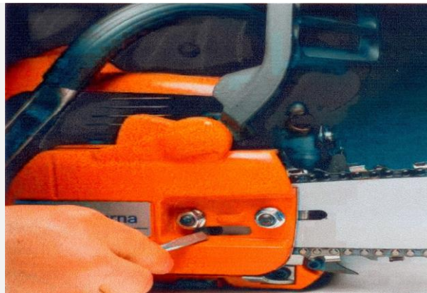
System boczego napinania łańcucha
