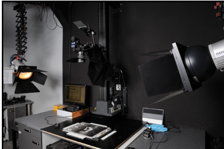
28. Urządzenie do skanowania obiektów płaskich oparte na aparacie cyfrowym. Elektryczna kolumna reprodukcyjna oraz ruchomy blat zapewniają reprodukcję szerokiego zakresu formatów. Pracownia digitalizacji Muzeum Historii Fotografii w Krakowie. Fot. W. Staszkiwicz
