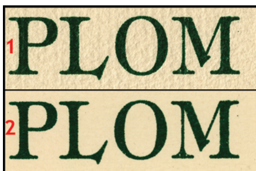
12. Przykłady skanów papieru czerpanego z zastosowaniem: 1. światła kierunkowego, 2. światła symetrycznego. Fot. W. Pyzik
