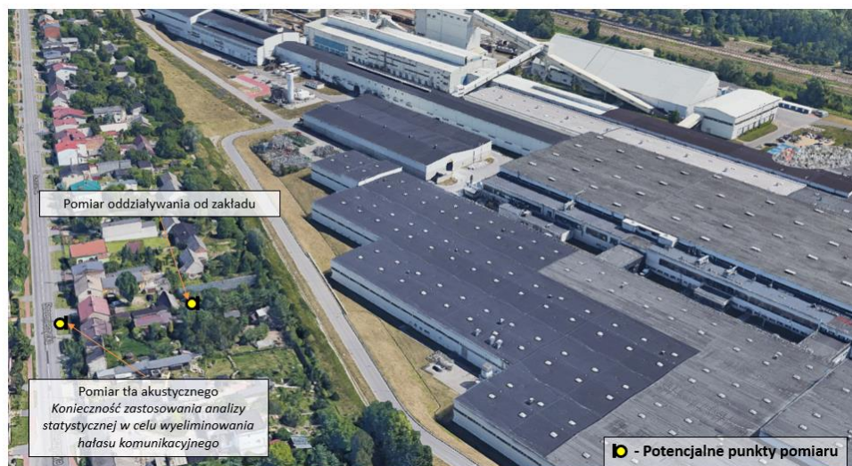
Rysunek C.28 Dobór punktów pomiarowych oddziaływania zakładu i tła akustycznego – przykład [podkład mapowy: GoogleEarth]
