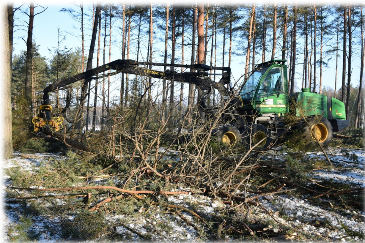
Fot. 31. Harvester w trakcie wykonywania rębni (MP).
