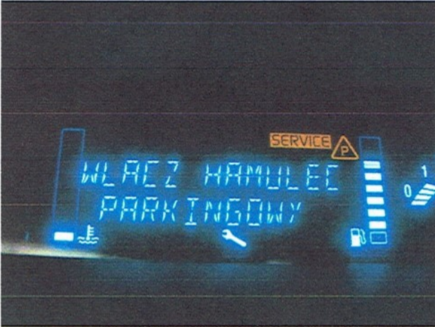
Fot. nr 11 komunikat o niesprawności hamulca postojowego
