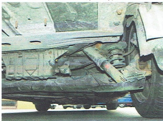
Fot. nr 22 zawieszenie TP – elem. stalowe skorodowane
