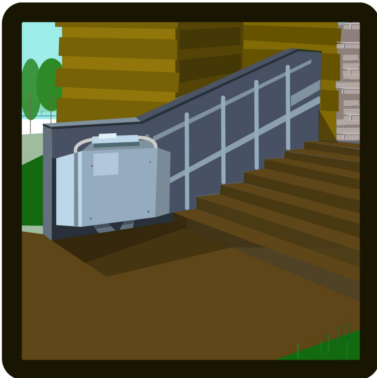
Zewnętrzna platforma przyschodowa – ukośna
