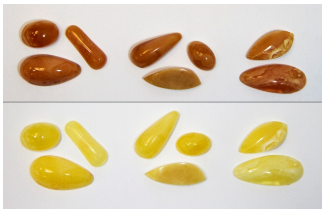
Fot. 5. Na górze bursztyn po napromieniowaniu dawką 115 kGy. Pod spodem bursztyn w naturalnej barwie. Od lewej po 3 próbki napromieniowane odpowiednio w azocie, powietrzu i wodzie.
