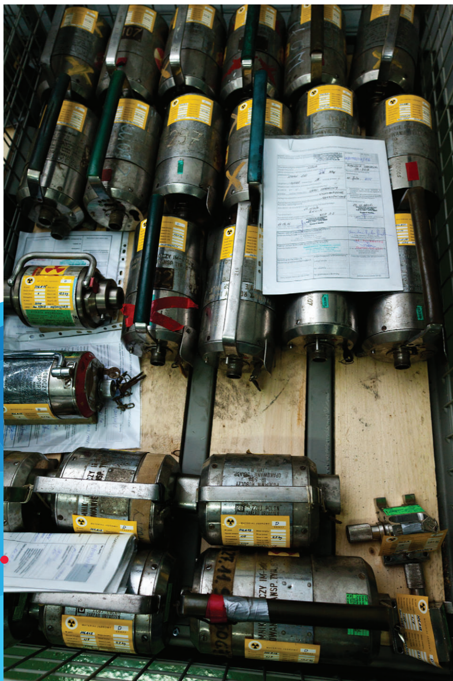
Defektoskopy oczekujące na wymianę w nich zamkniętych źródeł promieniotwórczych w Zakładzie Unieszkodliwiania Odpadów Promieniotwórczych
