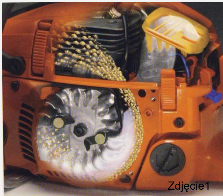
Oczyszczanie zassanego powietrza w filtrze odśrodkowym
