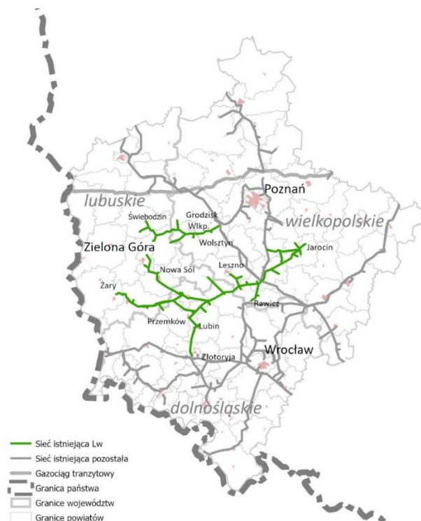
Rysunek 10. System przesyłowy gazu ziemnego zaazotowanego
