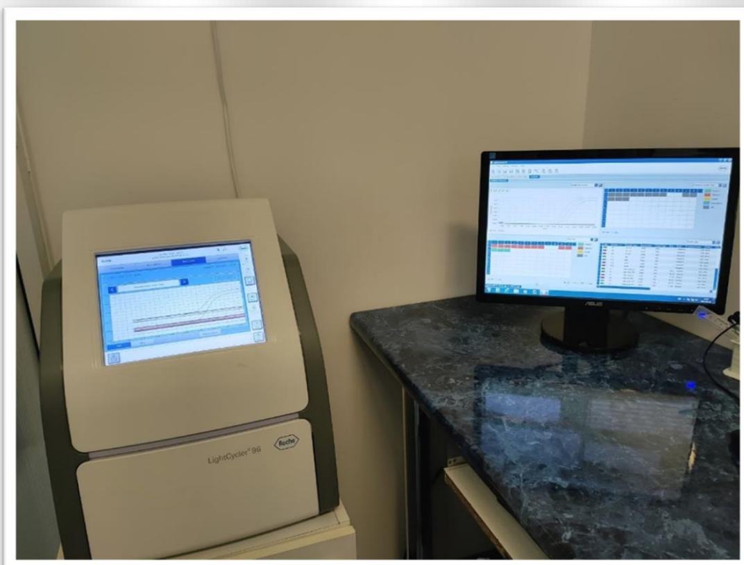
Wykrywanie obecności bakterii chorobotwórczych w żywności metodą rt PCR, przy użyciu aparatu Light Cycler 96. Zdjęcie WSSE Białystok - zasoby własne.
