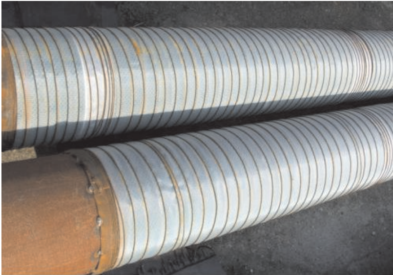
Rys. 14.10. Widok filtrów siatkowych
