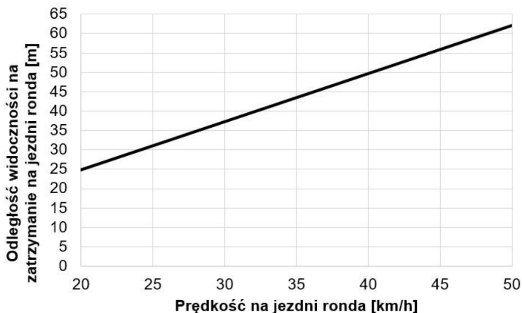
Rys. 4.3.2. Odległość widoczności na zatrzymanie mierzona do kolejnego pojazdu na jezdni ronda
