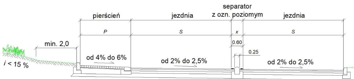
Rys. 7.3.1. Przekrój przez jezdnię ronda turbinowego
