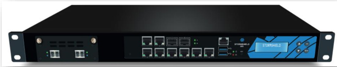
Fot. 36 Urządzenie zabezpieczające sieć teleinformatyczną Stormishield SN 710.
