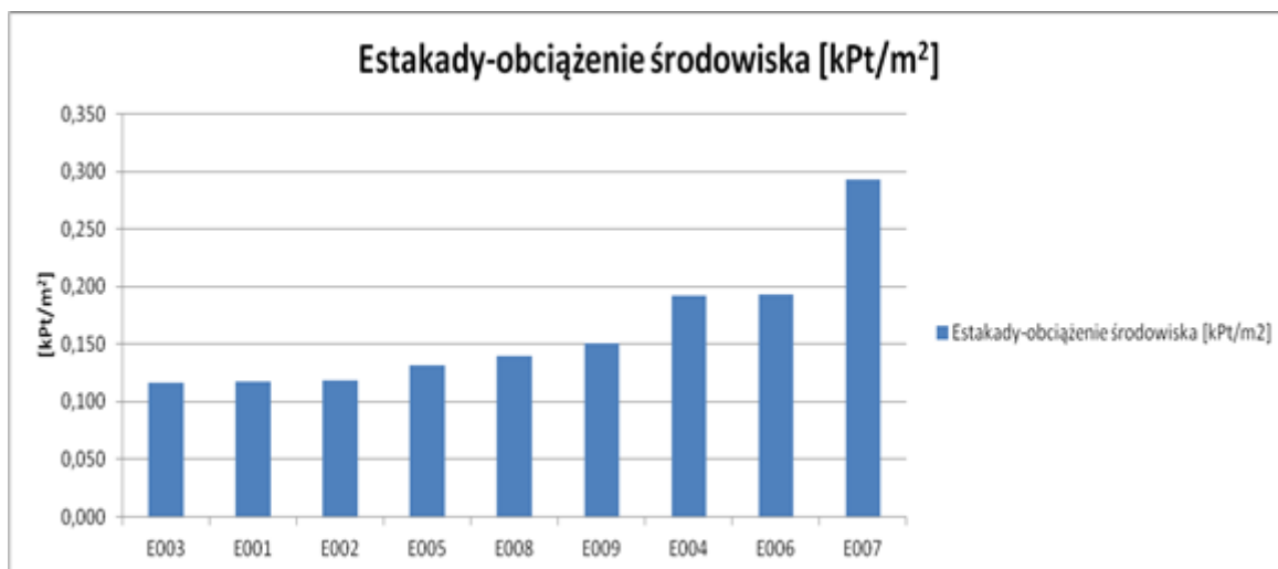
Rys. 33. Porównanie analizowanych estakad pod względem obciążenia środowiska przypadającego na 1m 2 powierzchni obiektu
