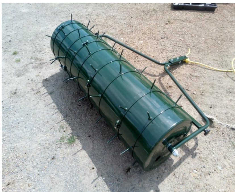
Fotografia 25. Walec hakujący z kolcami prostymi stosowany do usuwania pędów zakorzenionych w dnie (fot. M. Draga).
