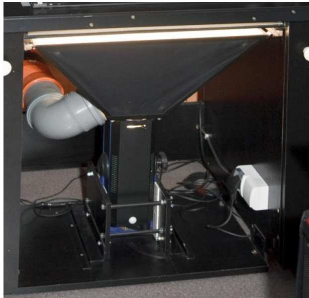
Ilustracja 3.60. Element konstrukcji urządzenia do reprodukcji klisz szklanych. Komora dyfuzyjna, „klimatyzacja” komory i mocowanie lampy błyskowej, Muzeum Historyczne Miasta Krakowa. Fot. W. Pyzik
