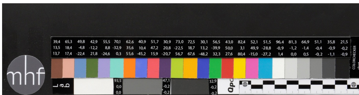
Ilustracja 3.96. Nowego typu tablica testowa samodzielnie wykonana w PDO. Pola barwne zostały wykonane z dużej tablicy 24-polowej ColorChecker, szara skala z testu QP Card 101. Skala metryczna o dokładności 1 mm/10 cm. Pola barwne zostały zmierzone spektrofotometrem o dokładności L^*a^*b^* = 0,1 , a otrzymane wielkości referencyjne zapisane są ponad nimi. Taki test pozwala na dokładne sprawdzenie jakości zapisu kolorów i umożliwia ewentualne późniejsze korekty.
