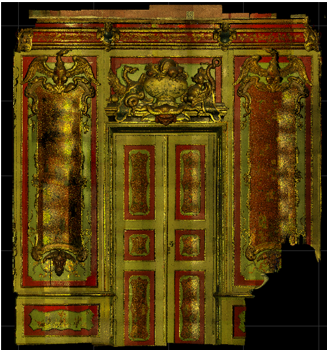
Ilustracja 3.77. Jedna ze ścian złożona z trzech fragmentów. Seria ilustracji pokazująca postępy w składaniu danych z pomiarów kierunkowych w jedną chmurę punktów – przedstawiającą całą ścianę wschodnią Gabinetu Chińskiego Króla. Fot. R. Sitnik
