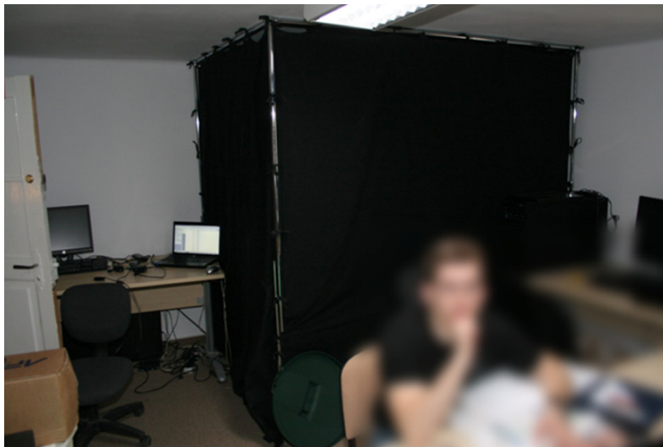
Ilustracja 3.81. Przykładowa zabudowa stanowiska pomiarowego. Wnętrze pracowni pomiarów 3D w Muzeum Pałac w Wilanowie. Widoczna zabudowa z czarnej tkaniny umożliwiająca zaciemnienie stanowiska pomiarowego. Muzeum Pałac w Wilanowie. Fot. P. Bolewicki
