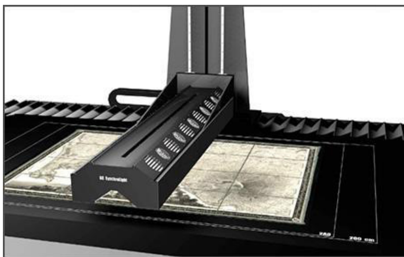
Ilustracja 11. DC SynchroLight” – komora światła synchronicznego w skanerze DRS 2A0 DCS, http://www.metis-digital.com/English/Products/PDF/DRS%20A0%20DCS/Brochure/index.html
