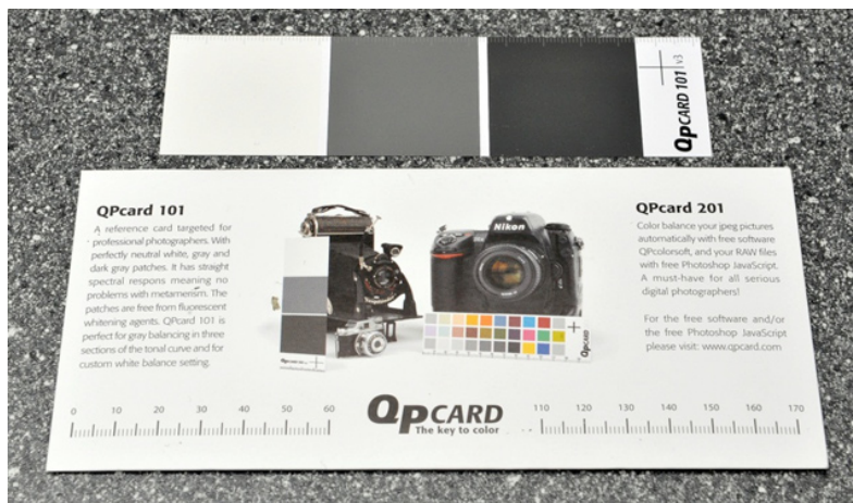
Ilustracja 3.93. Karta wzorcowa z trzema poziomami szarości o bardzo dobrych parametrach. Może służyć jako materiał do wykonania różnego rodzaju wzorców dopasowanych wielkością i układem do obiektu, który podlega digitalizacji. Fot. W. Staszkiwicz, Muzeum Historii Fotografii
