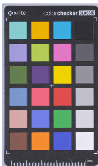
Ilustracja 3.92. Najczęściej używana tablica wzorcowe ColorChecker z 24 polami. Fot. W. Staszkiwicz, Muzeum Historii Fotografii
