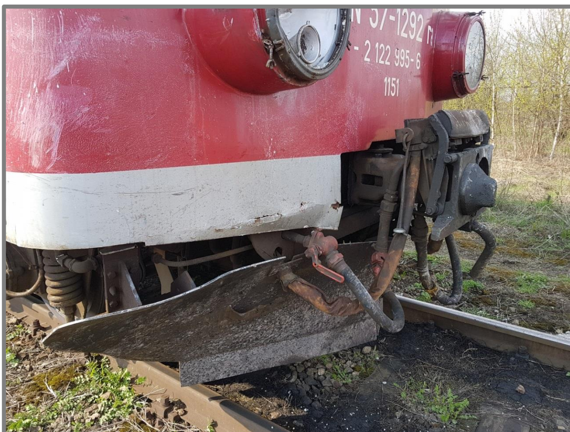
Widok elektrycznego zespołu trakcyjnego serii EN57-1292 po wypadku
