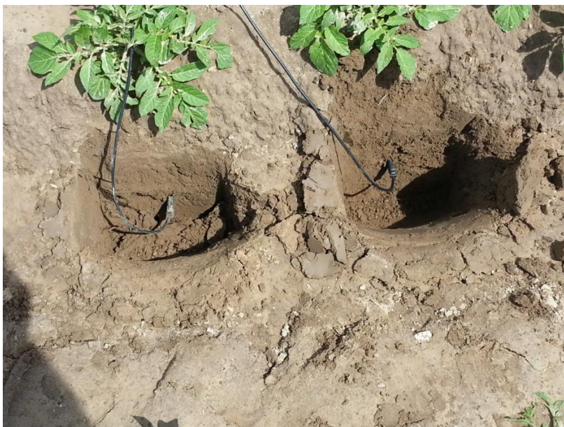
Rysunek 61. Czujniki z bezprzewodowym przekaźnikiem umieszczone w uprawie ziemniaka
