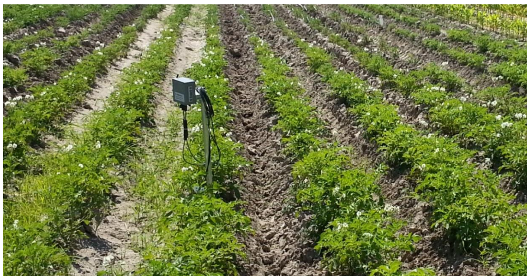
Rysunek 61. Czujniki z bezprzewodowym przekaźnikiem umieszczone w uprawie ziemniaka
