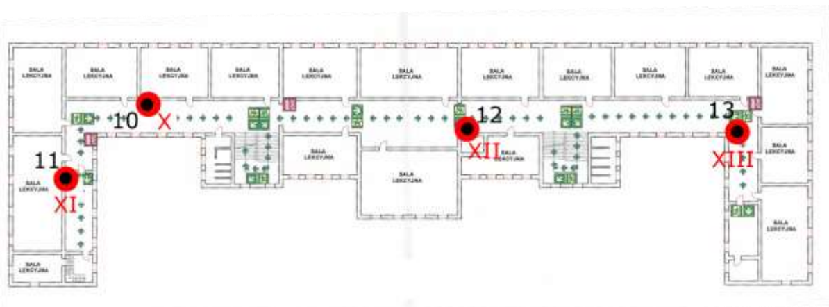
Rys. 1c: Plan rozmieszczenia punktów pomiarowych – II piętro, kolorem czerwonym oznaczono lokalizację punktów dostępnych
