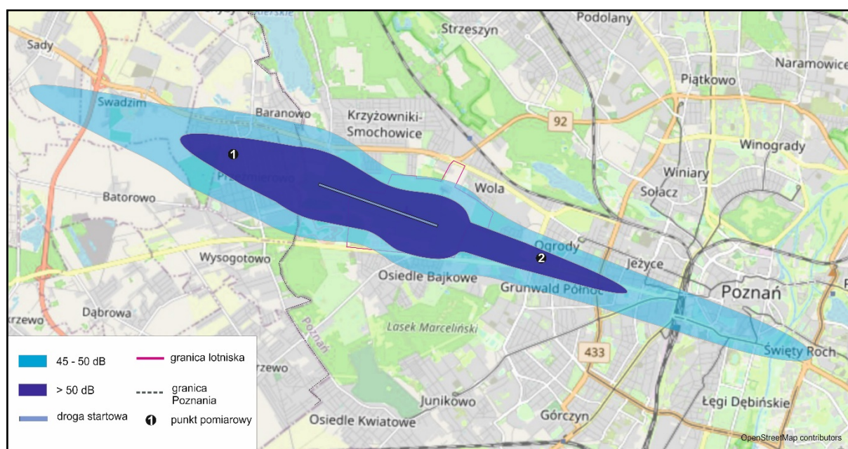
Mapa 20. Lokalizacja punktów pomiarowych hałasu lotniczego i izolinie długookresowego średniego poziomu dźwięku A wyznaczonego w ciągu wszystkich nocy w roku 2023 ( L_N ) emitowanego przez samoloty podczas wykonywania operacji lotniczych - lotnisko Ławica (źródło: Port Lotniczy Poznań – Ławica Sp. z o.o.)
