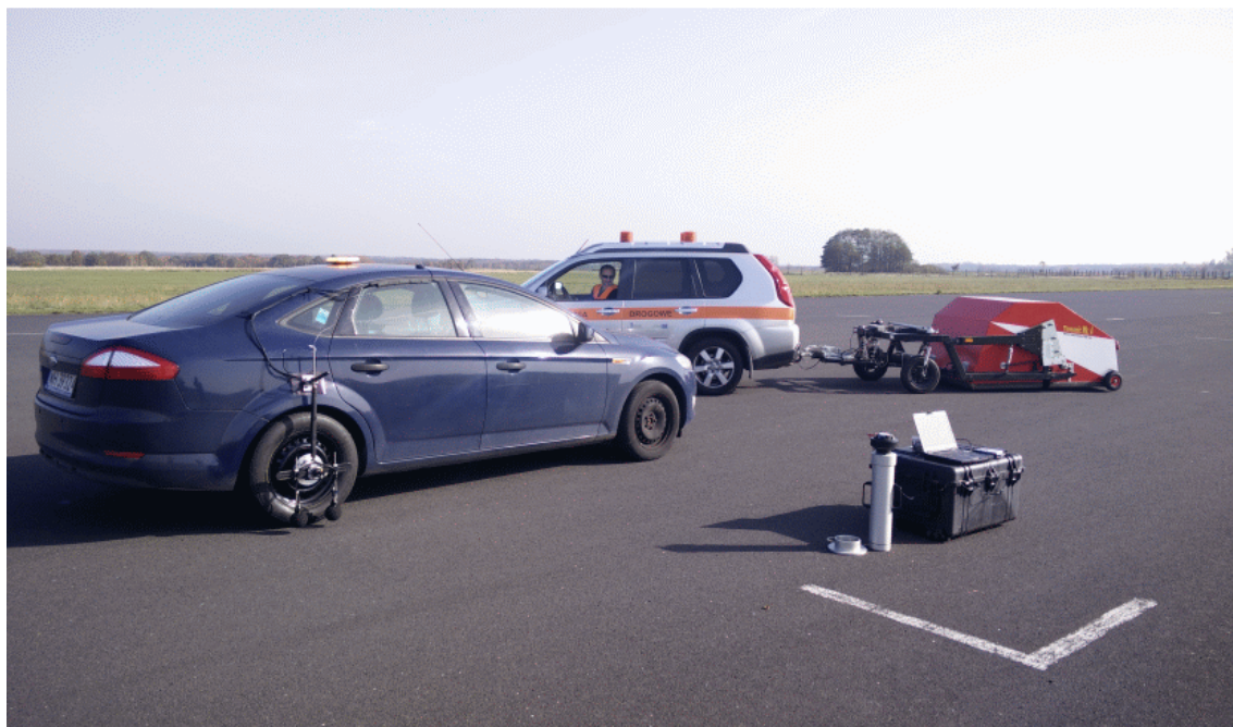
Rysunek 29. Urządzenia OBSI, CPX oraz ROSSA (tuba) na lotnisku w Uleżu
