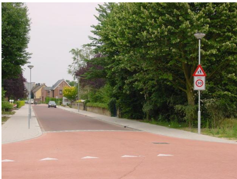
Fot. 4.20. Powierzchnia wyniesiona wyróżniona dodatkowo barwą nawierzchni
