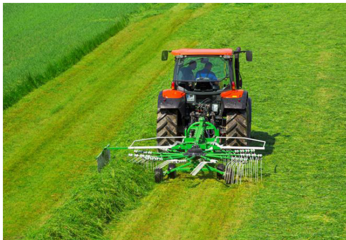
Zgrabiarka jedno-karuzelowa Z410 produkowana przez SaMASZ Sp. z o.o. z Białegostoku
