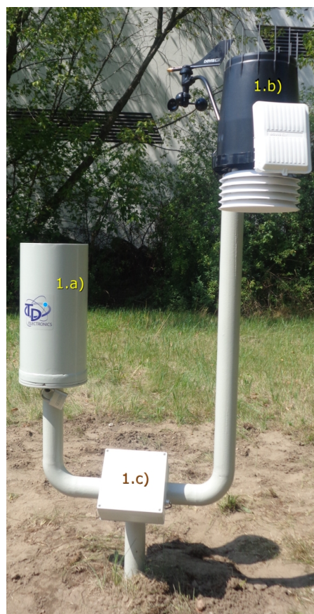
Fot. 1. Urządzenia stacji TDPMS3 umieszczone na zewnątrz budynku (moduł zewnętrzny). Oznaczenia odpowiadają opisowi w tekście.
