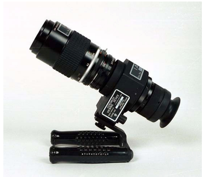
Rys. 4. Pomiar wypalonego paliwa – detektor promieniowania Czerenkowa ( Improved Cerenkov viewing device – ICVD ) (źródło: IAEA).
