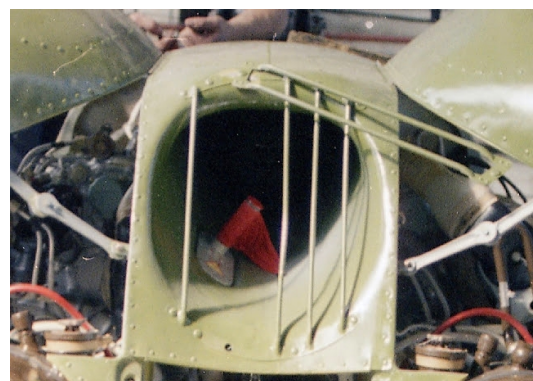
Rys. 2. Radioizotopowy sygnalizator oblodzenia montowany w śmigłowcach [1].
