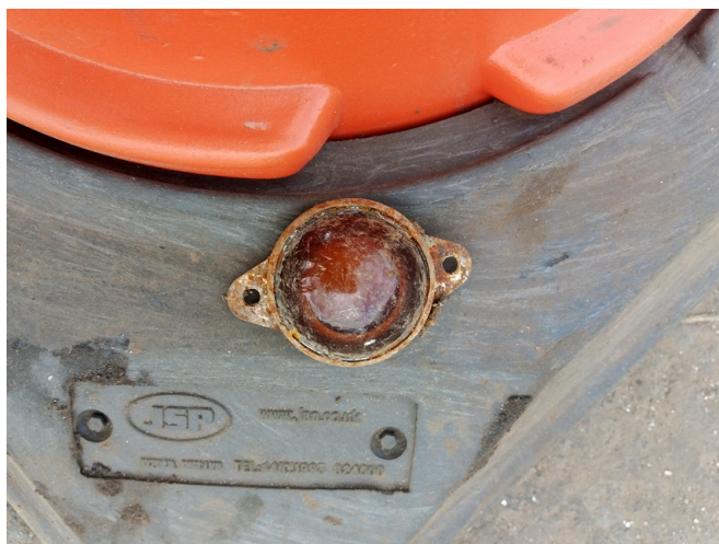
Rys. 13. Wykryty w odpadach sygnalizator oświetleniowy wykazujący podwyższoną moc dawki (fot. Ekipa Dozymetryczna PPAA).
