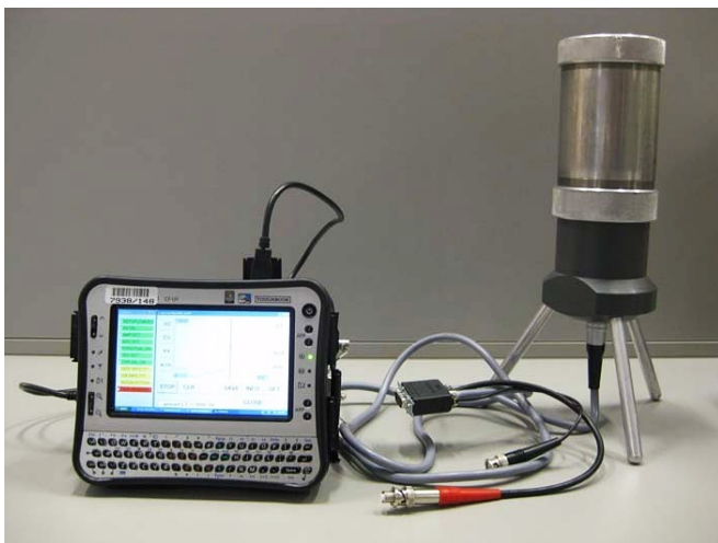
Rys. 1. Miniaturowy wielokanałowy analizator z detektorem NaI i minikomputerem ( Miniature Multichannel Analyser – MMCN ) (źródło: IAEA).
