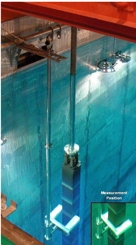
Rys. 3. Pomiar wypalonego paliwa – Fork Detector ( Fork detector irradiated fuel measuring system – FDET ) (źródło: IAEA).
