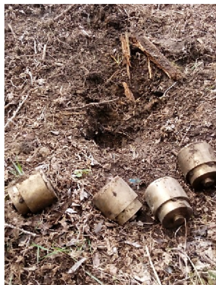
Rys. 9. Nieosłonięte, porzucone w przestrzeni publicznej źródła Co-60 (fot. Ekipa Dozymetryczna PPAA).
