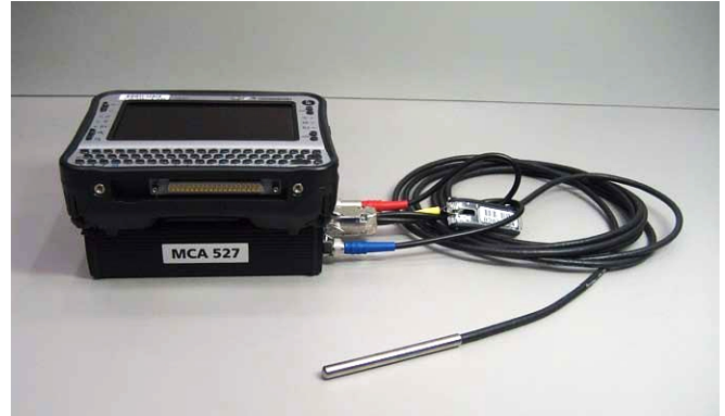
Rys. 2. Miniaturowy wielokanałowy analizator z detektorem CdZnTe i minikomputerem ( Miniature multichannel analyser with CdZnTe detector MMCC ) (źródło: IAEA).
