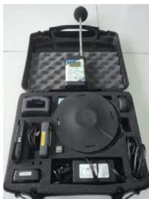
Zdjęcie 3. Miernik poziomu dźwięku SVAN 948 oraz zestaw do pomiaru drgań mechanicznych Vib008 – Pracownia fizyczna laboratorium Wojewódzkiej Stacji Sanitarno-Epidemiologicznej w Kielcach
