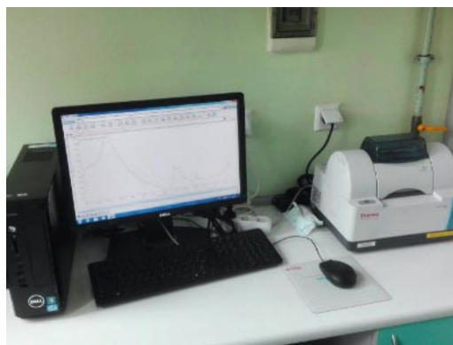
Zdjęcie 4. Spektrometr FT-IR Nicolet iS5 z wyposażeniem do oznaczania krystalicznej krzemionki – frakcja respirabilna pyłów (kwarc, krystobalit) – Pracownia pyłów i mikroklimatu laboratorium Wojewódzkiej Stacji Sanitarno-Epidemiologicznej w Kielcach
