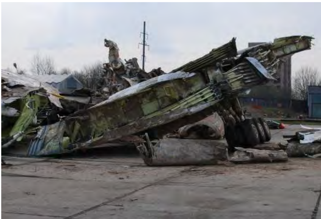
Rys. 16. Rozerwana krawędź natarcia lewego skrzydła
