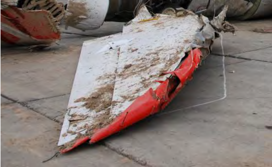
Rys. 20. Prawa część statecznika poziomego ze sterem wysokości
