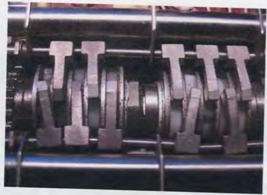
Рисунок 2.15 – Реконструкция контактной группы «единиц и десятков кГц» правого наборного устройства пульта аналога по контактной группе исследуемого наборного устройства аналога (а) и аварийного (б)
