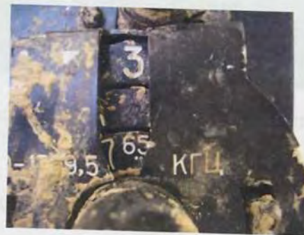
Рисунок 2.16 – Полученное значение частоты настройки на правом наборном устройстве пульта аналога в результате реконструкции
