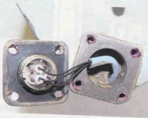
Рисунок 1.4 - Вид электрического соединителя: а - в состоянии поступления высотомера на исследование; б - после расстыковки ответных частей; в - после частичной разборки блочной части
