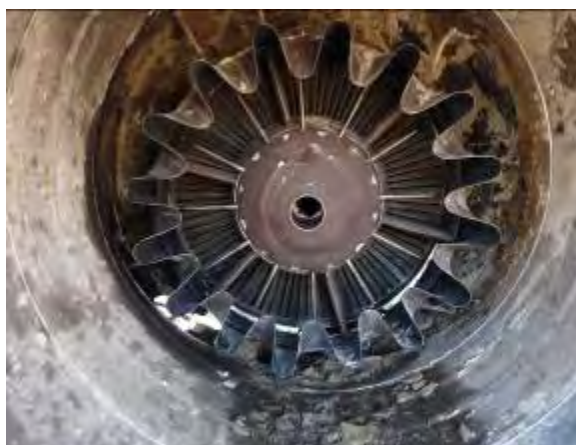
Zdj. 48. Widok ostatniego stopnia TNC i mieszalnika
