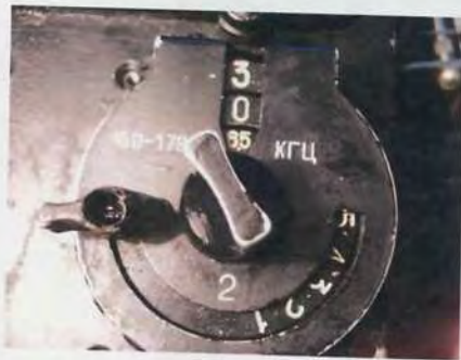
Рисунок 2.15 – Реконструкция контактной группы «единиц и десятков кГц» правого наборного устройства пульта аналога по контактной группе исследуемого наборного устройства аналога (а) и аварийного (б)
