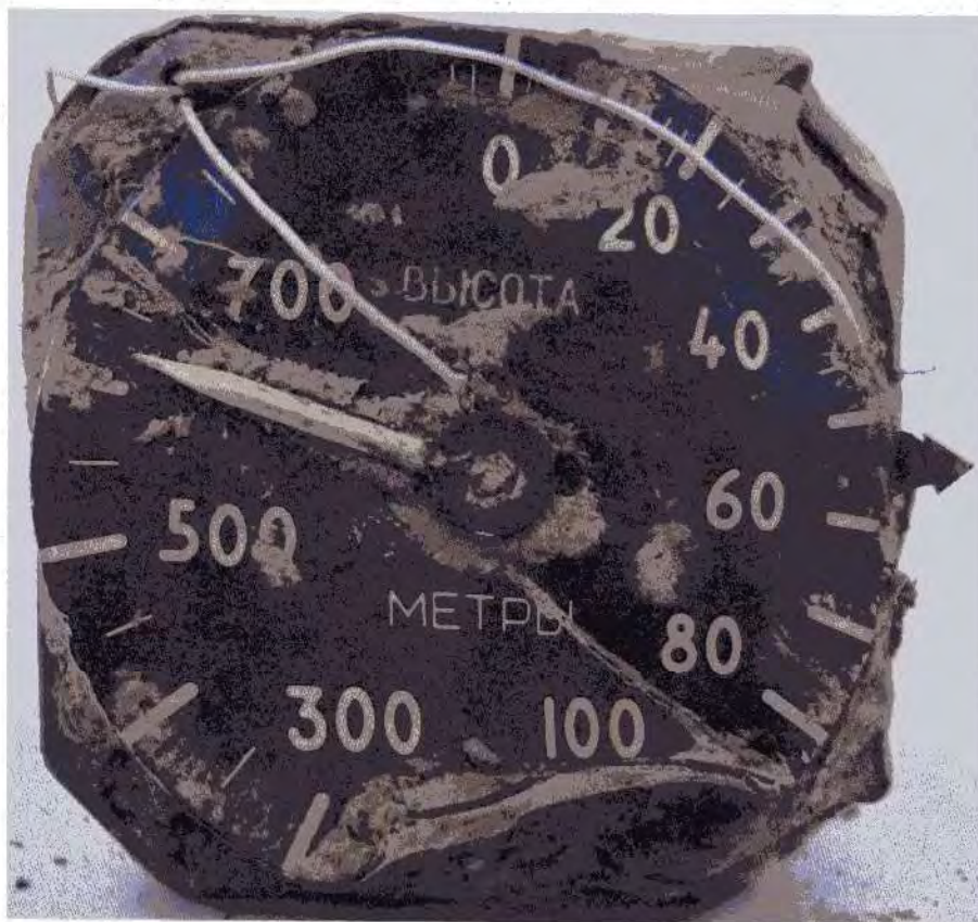
Рисунок № 2.30 - Внешний вид передней панели указателя А-034 №2 в момент поступления на исследование
