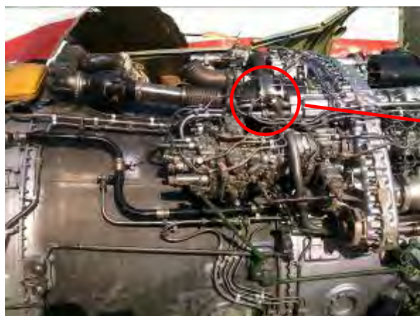
Zdj. 17. Widok agregatów silnikowych oraz elementów sterowania silnikiem po zdjęciu osłon
