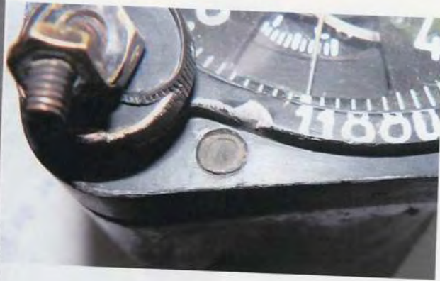
Рисунок 1.3 - Масляные пломбы с литерой «А» на головках винтов крепления: а - задней крышки; б - фланца
