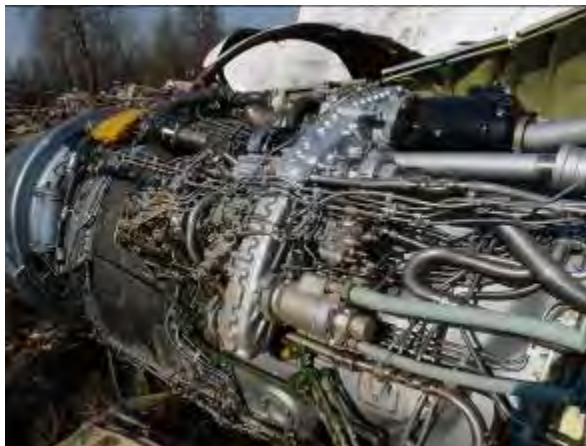
Zdj. 13. Widok agregatów silnikowych oraz elementów sterowania silnikiem po zdjęciu osłon
