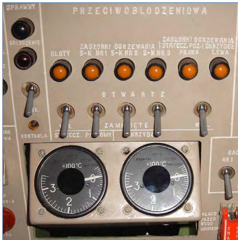
Rys. 29 Panel sterowania instalacją przeciwołdzeniową samolotu Tu-154M.
