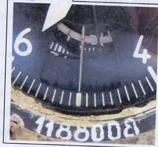
Рисунок 1.5 – Вид лицевой части высотомера BM-15ПБ № 1188008 в состоянии поступления на исследование. На выносках представлены: а - механическое повреждение ручки установки индекса заданной высоты (указано стрелками); б - окно с индексом отсчета барометрического давления и видимая часть барометрической шкалы
