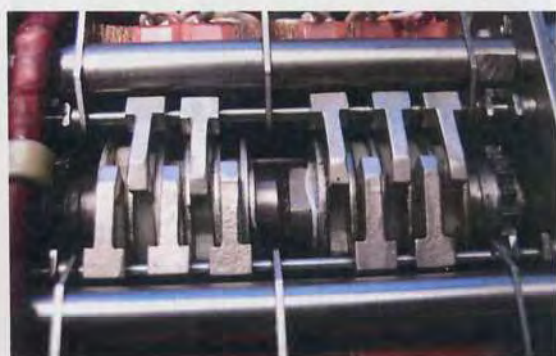
Рисунок 2.12 – Реконструкция контактной группы «единиц и десятков кГц» наборного устройства пульта аналога по контактной группе исследуемого наборного устройства аналога (а) и аварийного (б)
