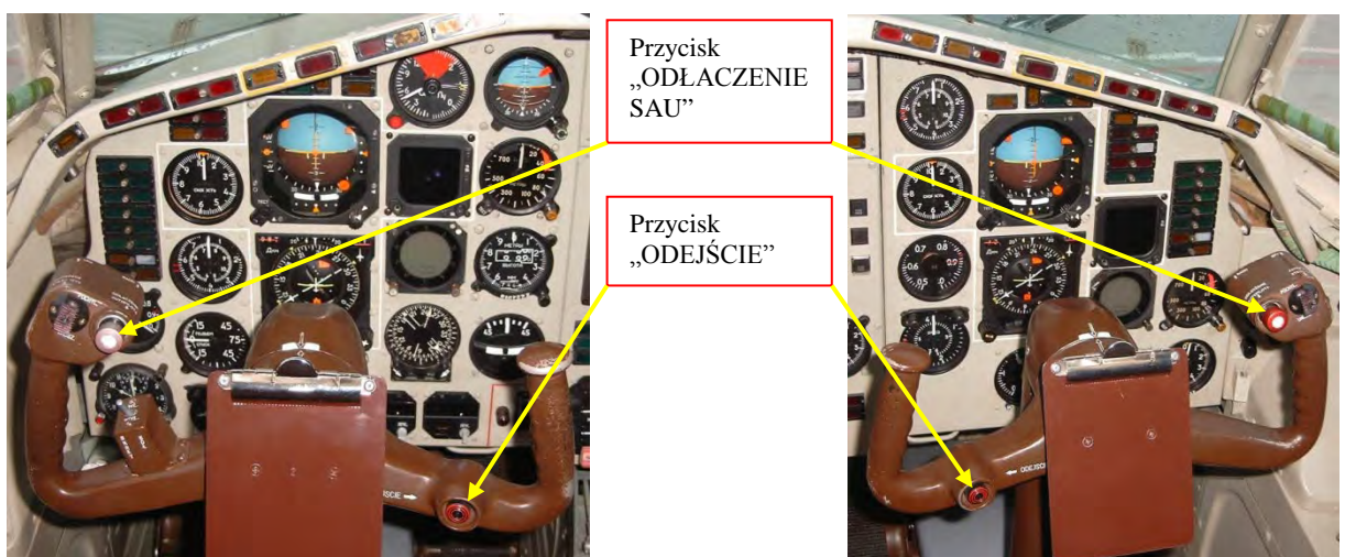
Rys. 18. Rozmieszczenie przycisków sterowania SAU na wolantach.
