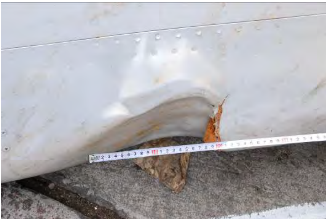
Rys. 3. Charakterystyczne owalne wgniecenia na krawędzi natarcia skrzydeł
