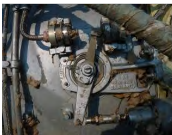
Zdj. 28. Noniusz ustawienia łopatek wlotowych AK SWC
