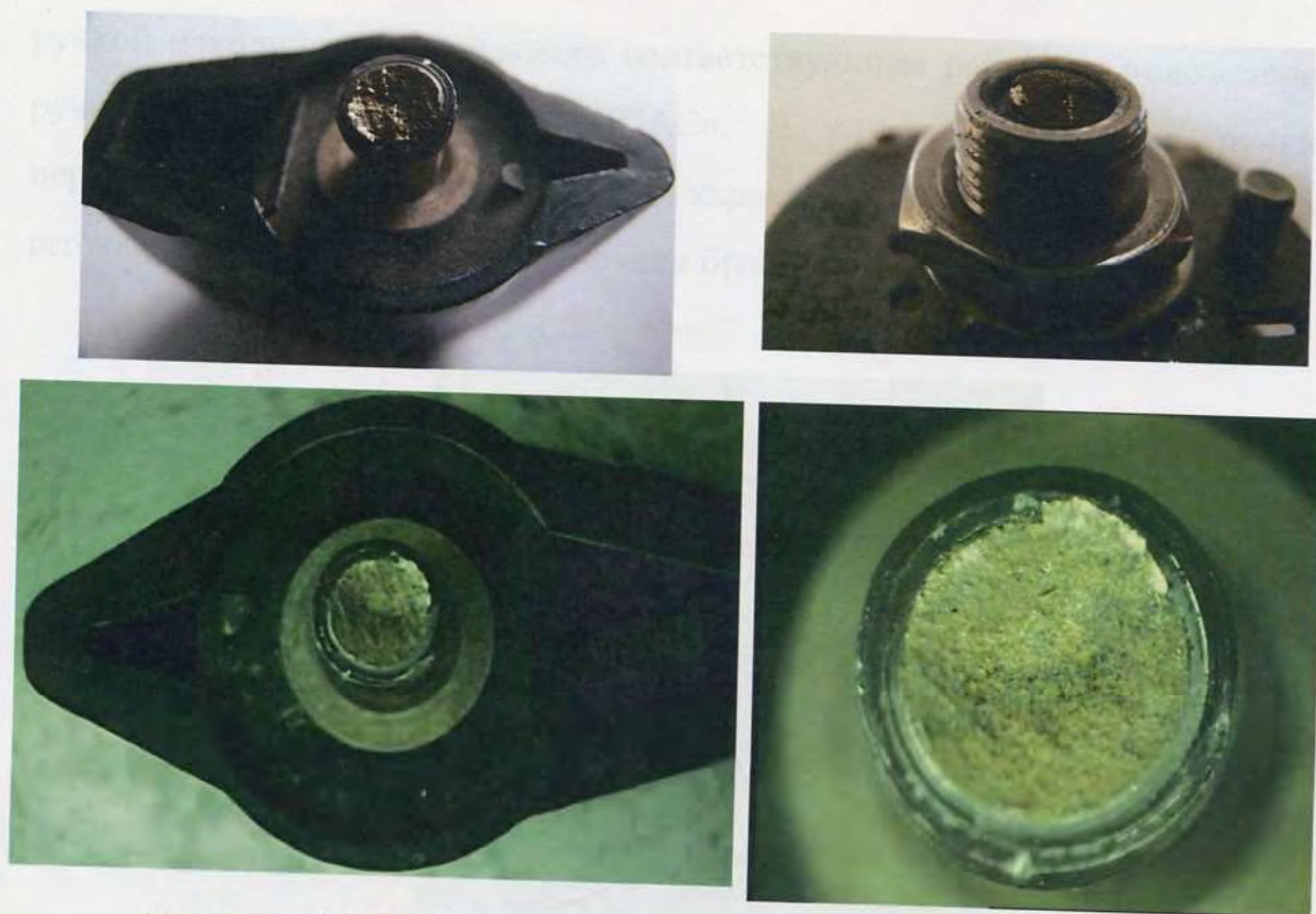
Рисунок № 2.17- Вид переключателя в месте его разрушения
