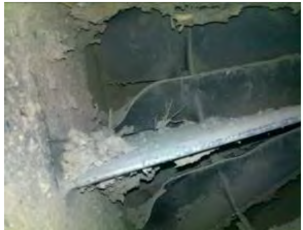
Zdj. 8. Widok uszkodzeń na krawędziach natarcia łopatek I st. SNC
