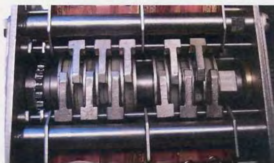
Рисунок 2.11 – Реконструкция контактной группы «сотен кГц» наборного устройства пульта аналога по контактной группе исследуемого наборного устройства аналога (а) и аварийного (б)
