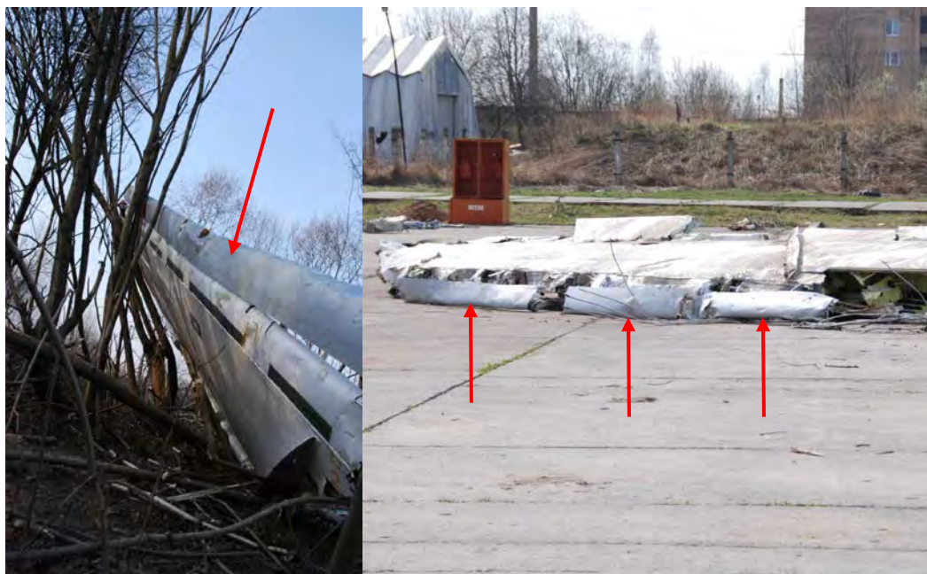
Rys. 7. Wypuszczone sloty lewego i prawego skrzydła samolotu
