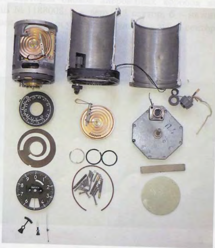
Рисунок 1.6 – Вид узлов anerоидных коробок высотомера VM-15ПБ № 1188008: а – после демонтажа задней крышки (стрелками указаны секторы, вышедшие из зацепления с центральной трибкой); б – после частичного препарирования прибора
