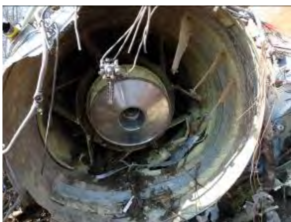
Zdj. 5. Widok stanu sprężarki niskiego ciśnienia
