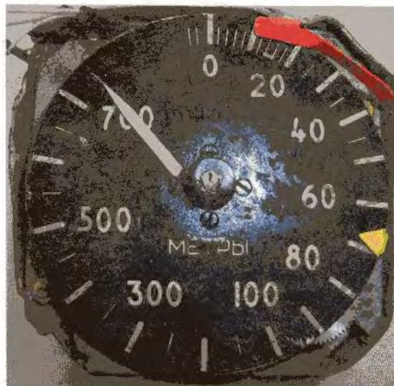
Рисунок № 2.26 - Внешний вид передней панели указателя А-034 №1 в момент поступления на исследование
