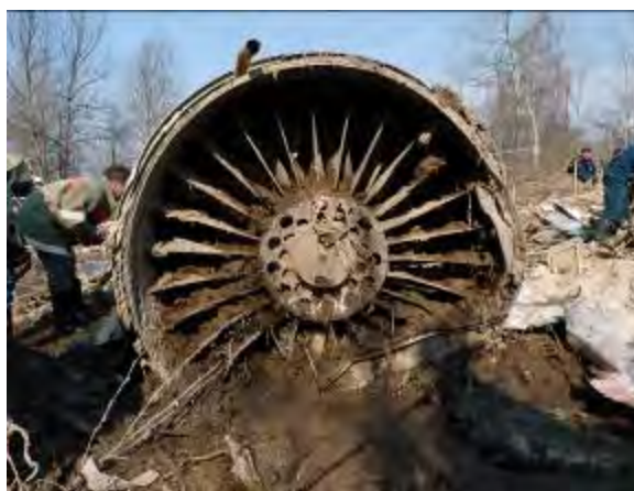
Zdj. 46. Widok łopatek wlotowego AK SNC
