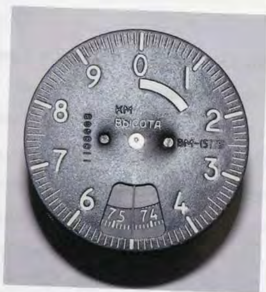
Рисунок 1.11 – Вид циферблата, барометрической шкалы и шторки высотомера BM-15ПБ № 1188008, выставленных в соответствии с выявленными первичными повреждениями зубьев зубчатых колес механизма кремальеры
