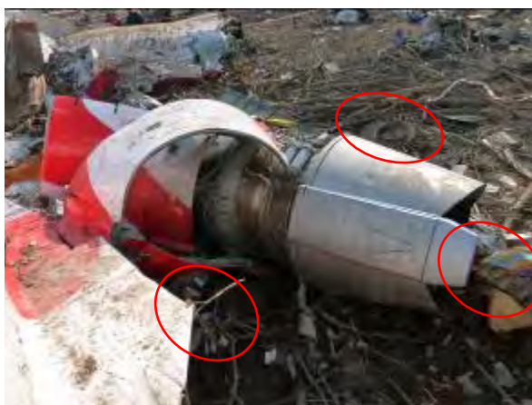
Zdj. 3. Widok silnika z jego prawej strony oraz tarcz z łopatkami SNC
