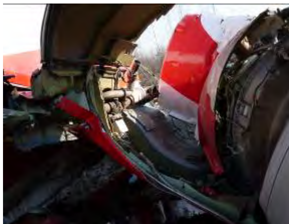
Zdj. 26. Widok prawej strony silnika i węzłów mocowanie do pylonu
