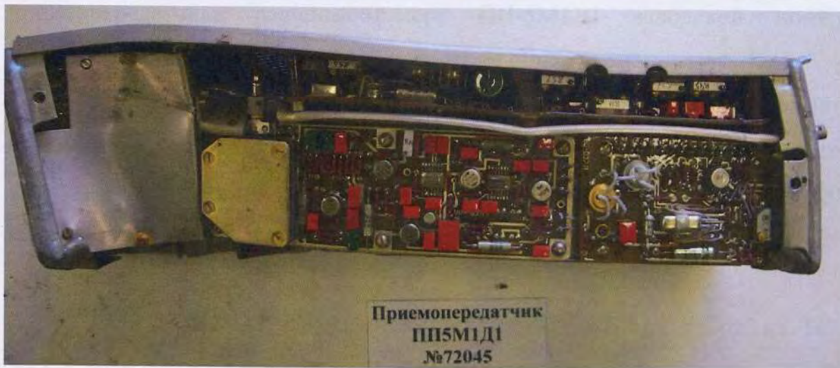
Рисунок № 2.39 - Внешний вид приемопередатчика радиовысотомера ПП-5М1Д1, зав. № 72045 после препарирования
