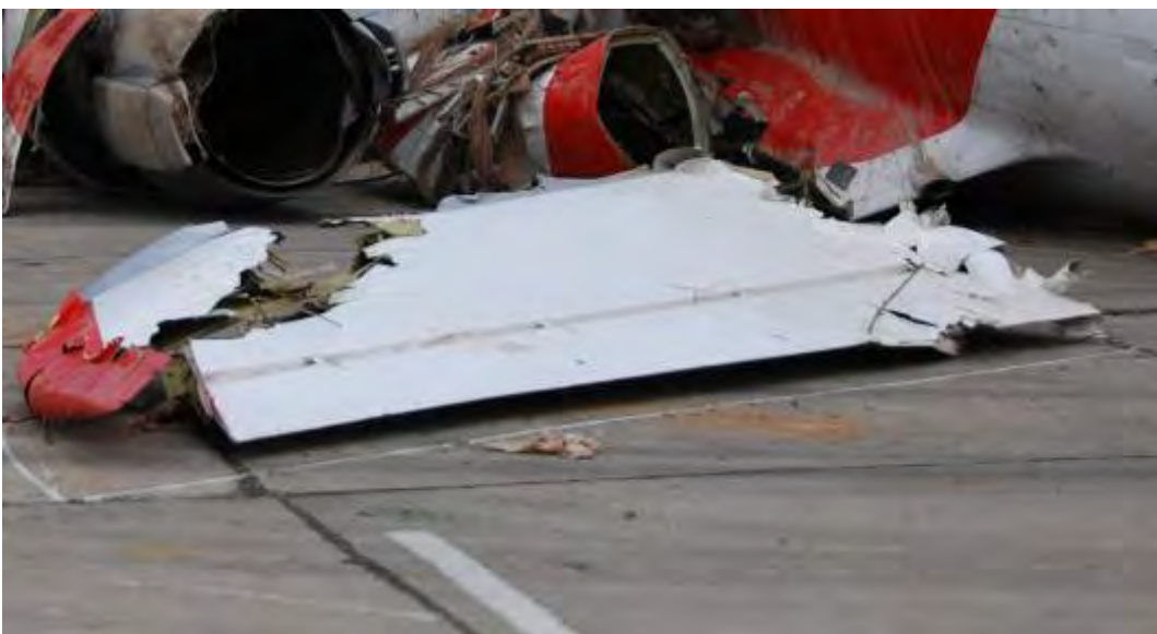
Rys. 21. Lewa część statecznika poziomego ze sterem wysokości
