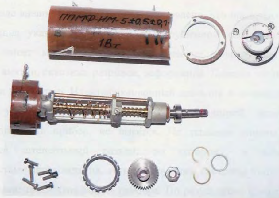
Рисунок 1.21 – Вид потенциометра ППМФ-ИМ-5±0,5±0,1-2 после его частичной разборки
