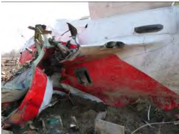
Zdj. 43. Widok kadłuba w miejscu mocowania silnika nr 3 do pylonu
