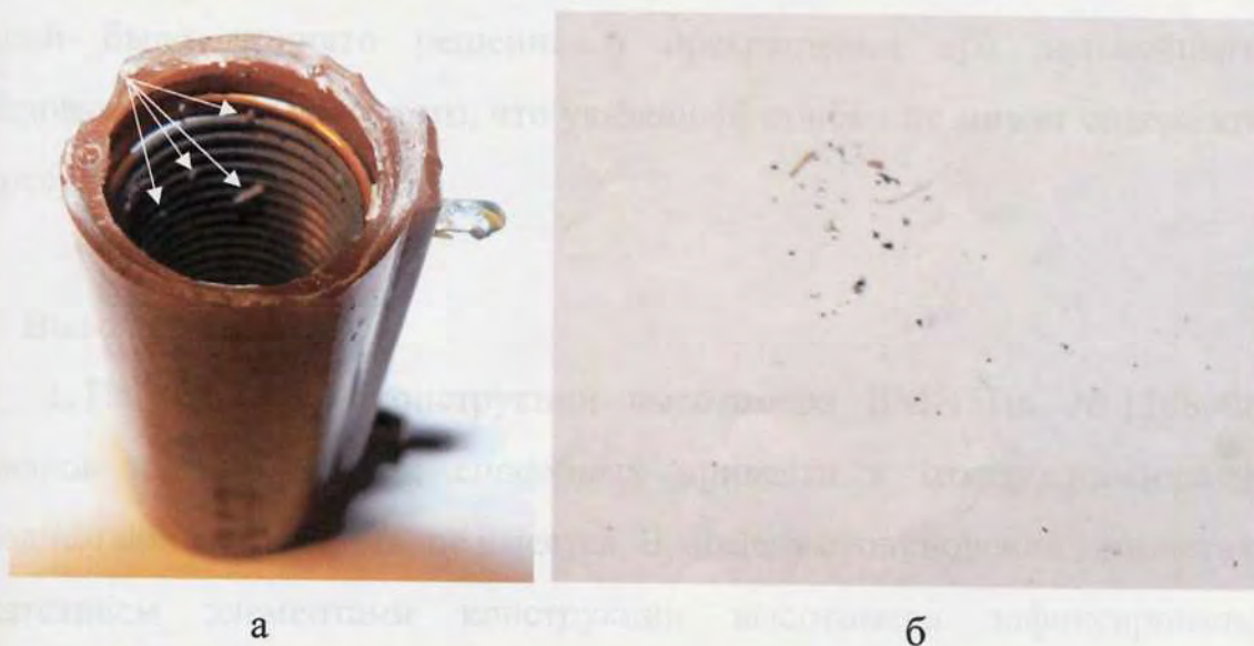
Рисунок 1.22 – Посторонние частицы (указаны стрелками) на обмотке потенциометра ППМФ-ИМ-5±0,5±0,1-2, обнаруженные при его частичной разборке (а) и после их извлечения (б)
