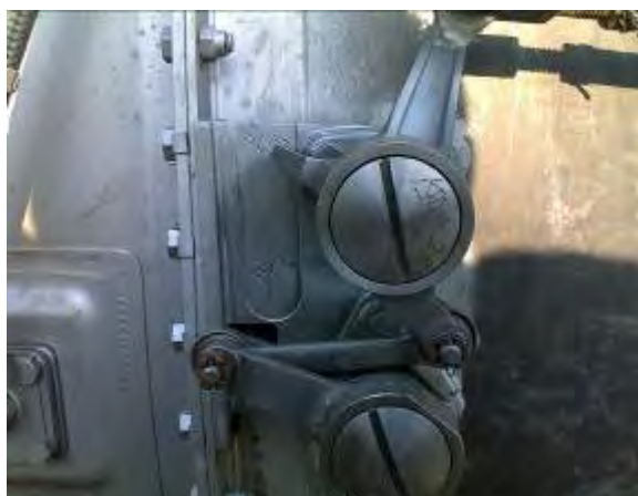
Zdj. 16. Widok stanu elementów sterowania rewerserem – wskaźnik położenia
