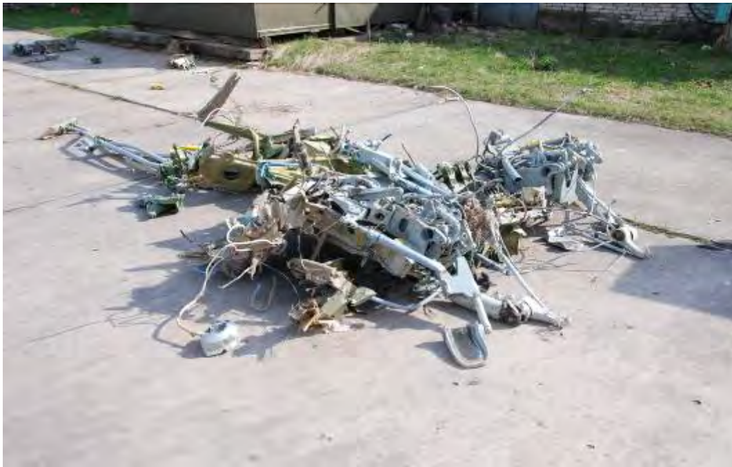
Rys. 26. Pozostałości układu sterowania samolotem – elementy zabudowane w kokpicie i pod podłogą kabiny załogi
