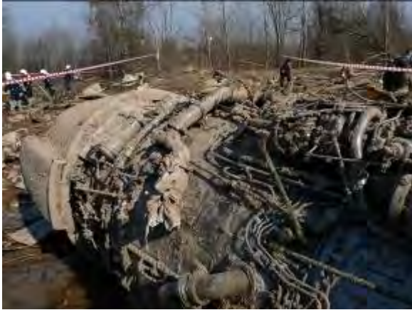
Zdj. 49. Widok agregatów silnikowych oraz elementów sterowania silnikiem (strona lewa silnika)
