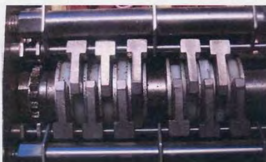
Рисунок 2.11 – Реконструкция контактной группы «сотен кГц» наборного устройства пульта аналога по контактной группе исследуемого наборного устройства аналога (а) и аварийного (б)
