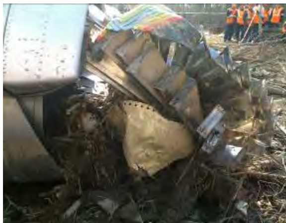
Zdj. 8. Tarcza z łopatkami roboczymi i łopatki aparatu kierującego SNC
