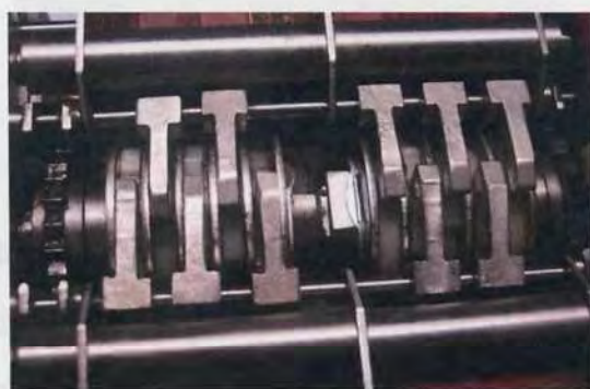
Рисунок 2.12 – Реконструкция контактной группы «единиц и десятков кГц» наборного устройства пульта аналога по контактной группе исследуемого наборного устройства аналога (а) и аварийного (б)
