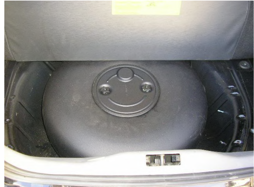
zbiornik o przekroju toroidalnym w wnękę na koło zapasowe
