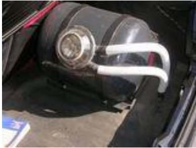
zbiornik o przekroju walcowym w bagażniku
