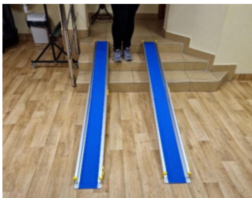
Aluminiowe szyny dwuelementowe przenośne na schodach.
