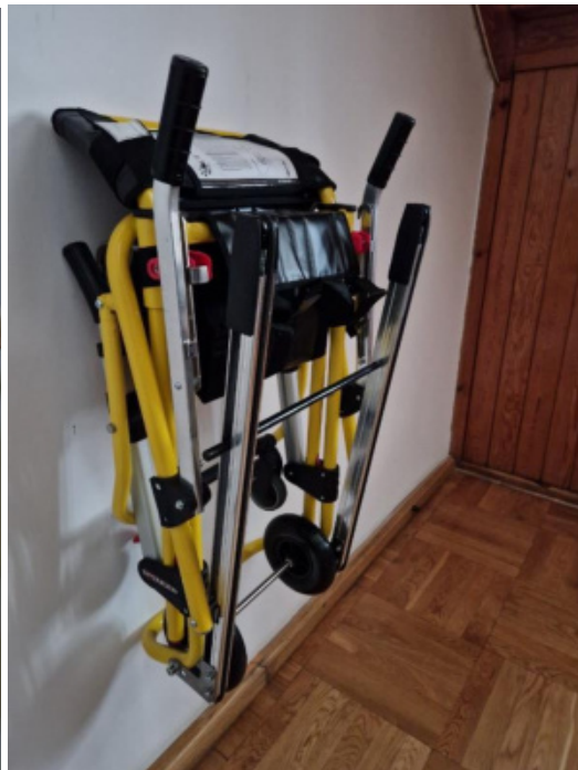
Krzesełko ewakuacyjne wiszące na ścianie.
