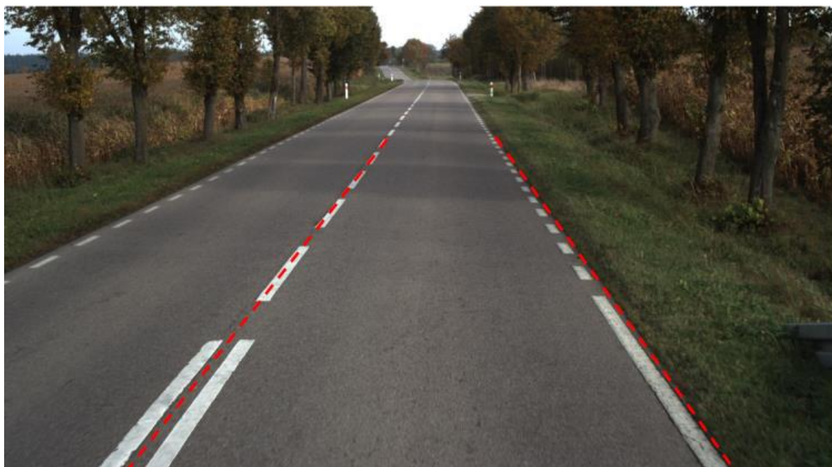
Rys. 4.5.4.1. Reguły wyznaczania pasa ruchu w przypadku występowania oznakowania poziomego
