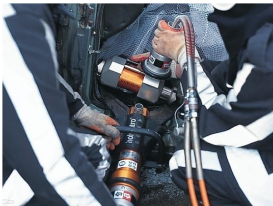
Fotografia nr 5.22. Rozpychanie progu (foto Holmatro)
