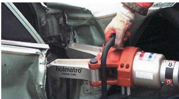
Fotografia nr 5.6. Rozpieranie od strony zawiasów (foto Holmatro)
