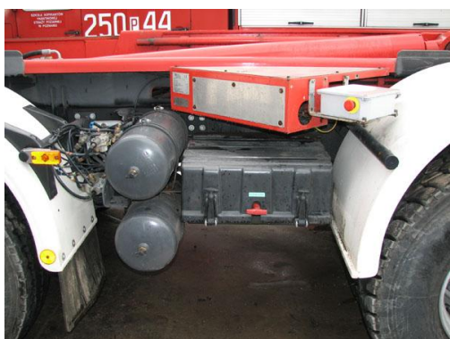
Fotografia nr 4.19. i 4.20. Umiejscowienie akumulatorów w ciężarówce i autobusie (foto Jacek Gawroński)
