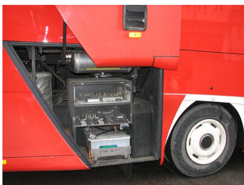
Fotografia nr 4.19. i 4.20. Umiejscowienie akumulatorów w ciężarówce i autobusie (foto Jacek Gawroński)
