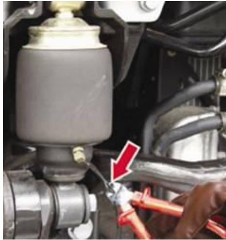
Fotografia nr 4.14. Przewód zasilający miech poduszki pneumatycznej (foto Mercedes-Benz)
