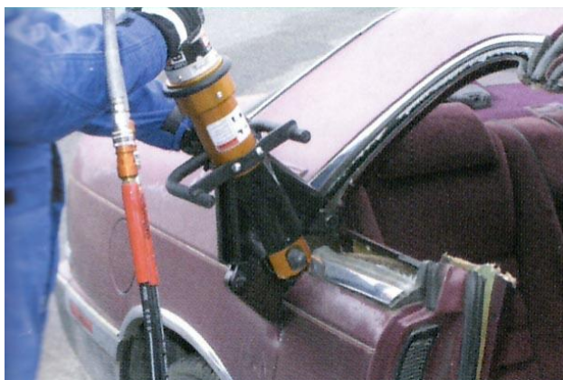
Fotografia nr 5.9. Wycinanie „trzecich drzwi” (foto Holmatro)
