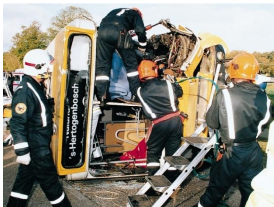
Fotografia nr 5.29. Dojście do uszkodzonych przez szybę przednią autobusu (foto Holmatro)
