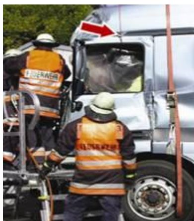
Fotografia nr 5.27. Zabezpieczenie drzwi podpinką (foto Mercedes-Benz)
