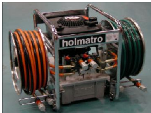
Fotografia nr 3.17. Agregat zasilający z silnikiem spalinowym i dwoma zwijadłami węzowymi
