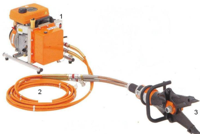
Fotografia nr 3.1. Podstawowy zestaw narzędzia dwustronnego działania z agregatem zasilającym: agregat zasilający (1), przewody hydrauliczne (2) i narzędzie (3)
