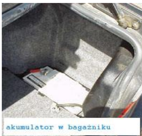
Fotografia nr 4.17. i 4.18. Umiejscowienie akumulatora w bagażniku i nadkolu (foto internet)
