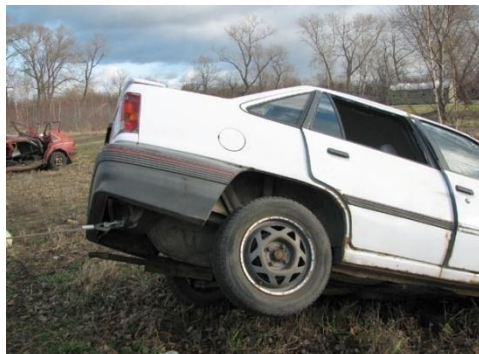
Fotografia nr 4.12. Zabezpieczenie pojazdu liną wyciągarki (foto Jacek Gawroński)
