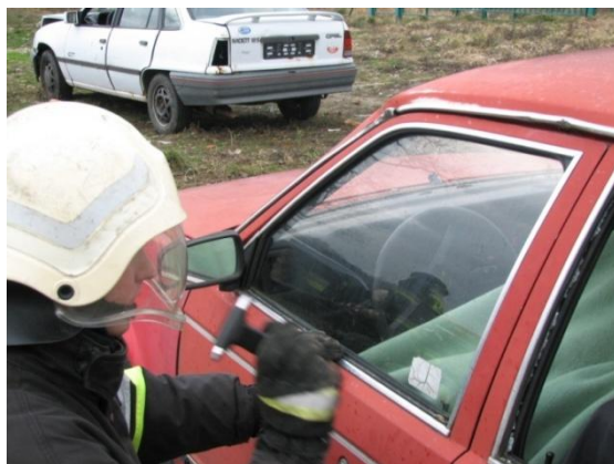
Fotografia nr 5.4. Usuwanie szyby bocznej hartowanej (foto Jacek Gawroński)
