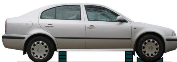
Rysunek nr 2.16. Stabilizacja pojazdu
