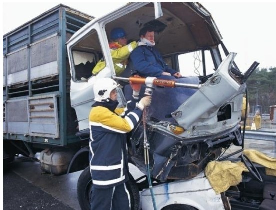
Fotografia nr 5.28. Rozpieranie przy pomocy rozpieracza cylindrycznego (foto Holmatro)
