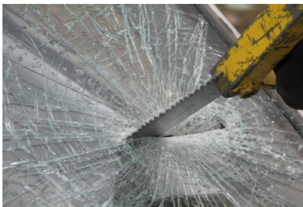
Fotografia nr 5.3. Usuwanie szyby przedniej klejonej (foto Jacek Gawroński)
