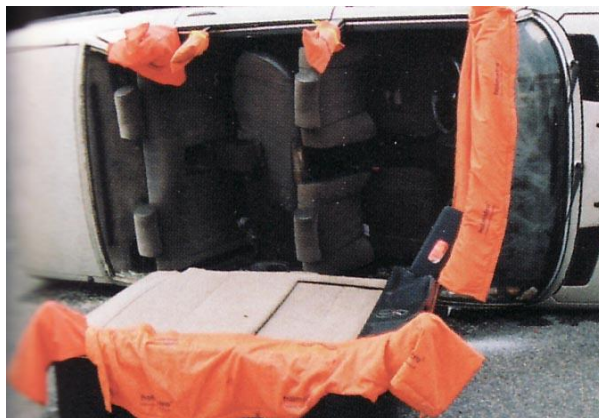
Fotografia nr 5.20. Odcięcie dachu na bok (foto Holmatro)
