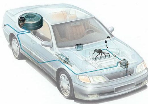
Rysunek nr 4.1. Schemat instalacji LPG w samochodzie osobowym (rysunek Internet)
