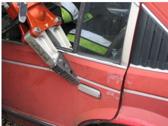
Fotografia nr 5.7. „Uszczyplnięcie” poszycia drzwi przy klamce (foto Jacek Gawroński)
