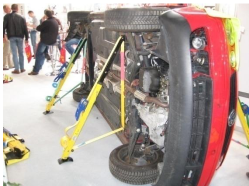
Fotografia nr 4.10. Stabilizacja pojazdu na boku (foto Jacek Gawroński)
