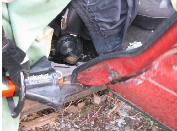
Fotografia nr 5.8. Wycinanie słupka C nad progiem (foto Jacek Gawroński)
