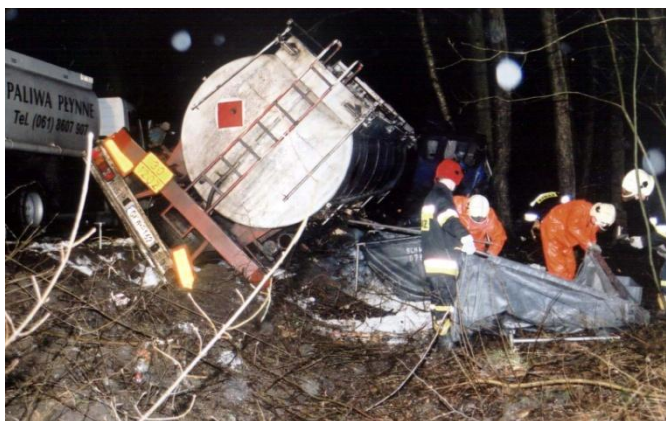
Fotografia nr 6.4. Ratownicy rozkładający folię w celu wylapywania wycieku substancji niebezpiecznej
