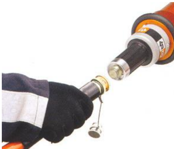
Fotografia nr 3.12. Łączenie przewodu systemu jednowężowego z narzędziem.
