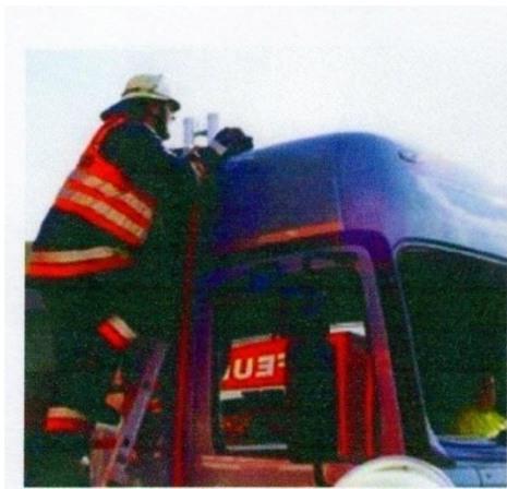
Fotografia nr 5.23. Stabilizowanie kabiny z drabiny (foto Mercedes-Benz)
