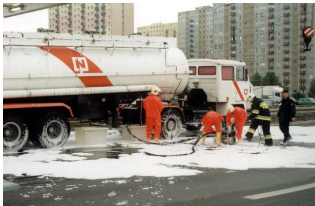
Fotografia 6.7. Cysterna z substancją ropopochodną zabezpieczona przeciwpożarowo poprzez położenie poduszki z piany gaśniczej oraz z wyciekami wylapywanym do podstawionych zbiorników
