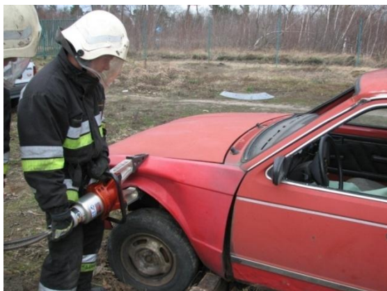
Fotografia nr 5.5. Ściskanie błotnika rozpieraczem (foto Jacek Gawroński)
