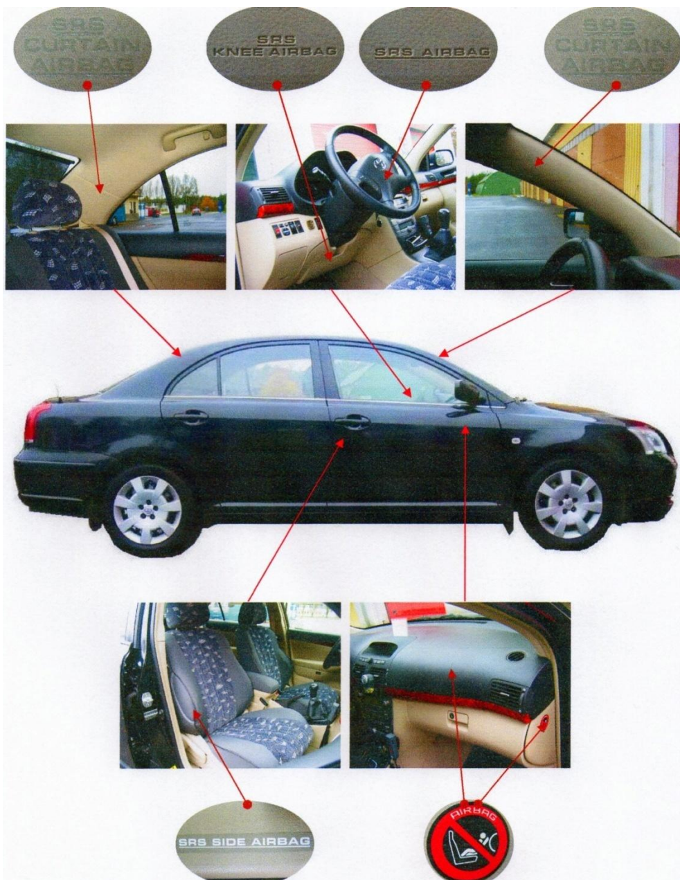
Rysunek nr 2.7. Rozmieszczenie i oznakowanie poduszek gazowych (Toyota Avensis)
