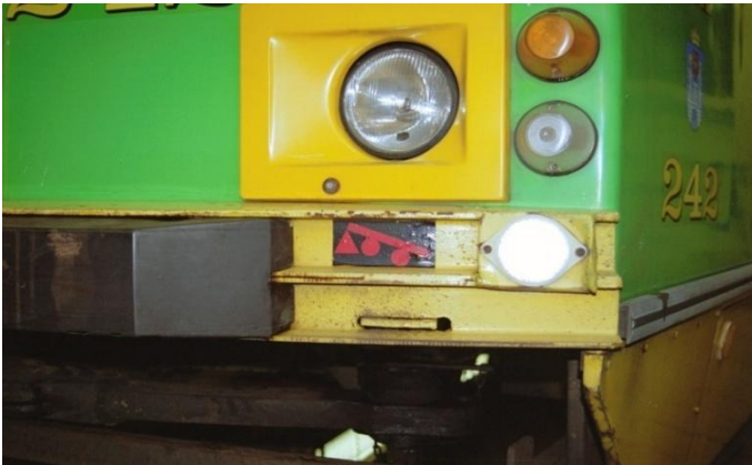
Fotografia nr 7.5. Oznakowanie punktu podnoszenia tramwaju (foto Piotr Guzewski)
