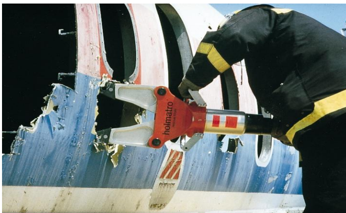
Fotografia nr 7.14. Oznakowany punkt cięcia w samolocie (foto Holmatro)
