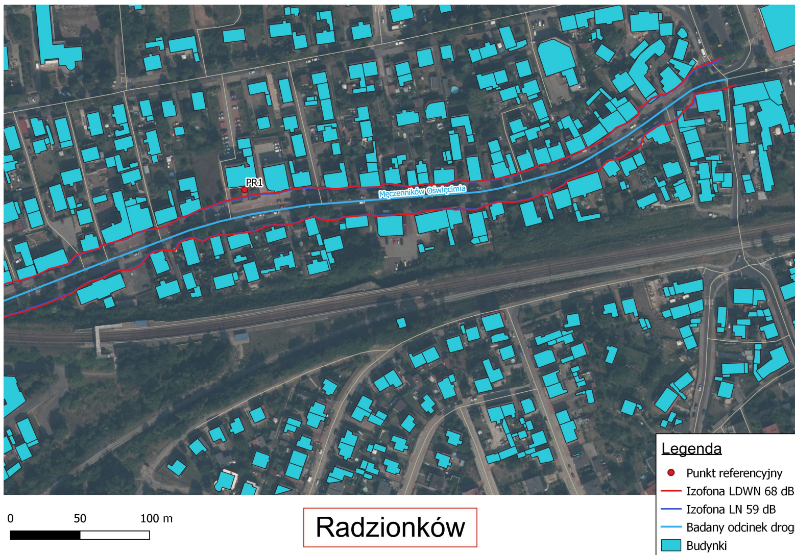
Ryc. 11. Mapa akustyczna dla wskaźnika oceny hałasu L_{DWN} i L_N w rejonie badań RB1 – Radzionków, ul. Męczenników Oświęcimia, 2018 rok.
